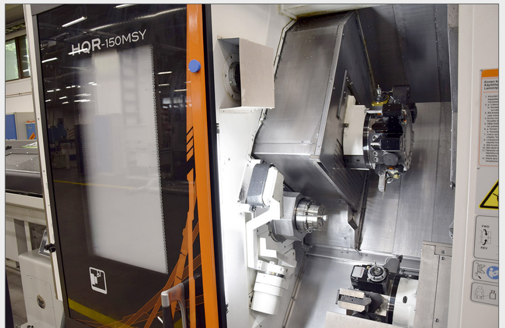
Mazakin Hyper Quadrex 150MSY on 2-karainen CNC-sorvi kahdella Y-akselirevolverilla ja pyörivillä työkaluilla ja C-akselilla. Tankosyöttölaite automatisoi toimintoja.
