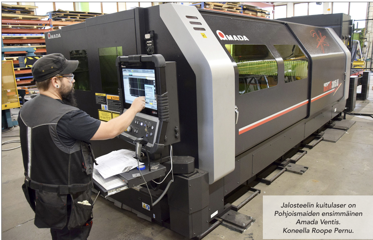
Koneen työalue on 1,5x3 metriä. Monet ominaisuudet ovat avuksi leikkaustöissä. Yksi keskeinen on uusi LBC-teknikka.
