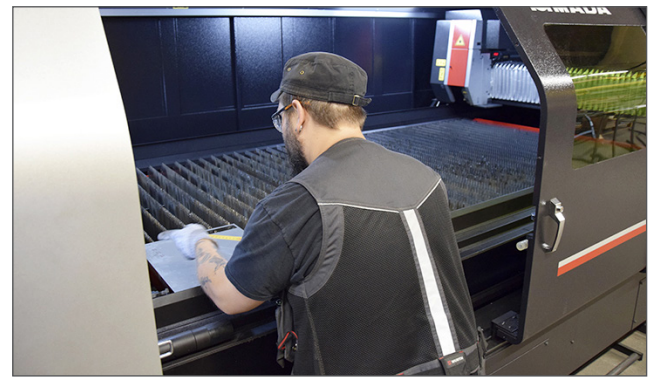
Koneen työalue on 1,5x3 metriä. Monet ominaisuudet ovat avuksi leikkaustöissä. Yksi keskeinen on uusi LBC-teknikka.
