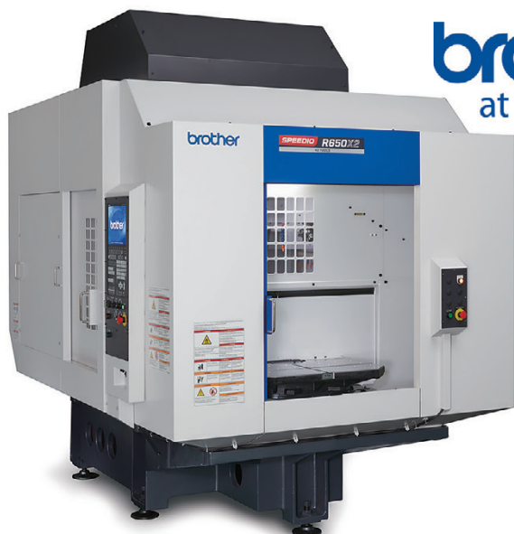
Brother R650X2-40T, pystykarainen koneistuskeskus: 40-paikkainen työkalumakasiini, paletinvaihtaja, kara 16000 min-1
