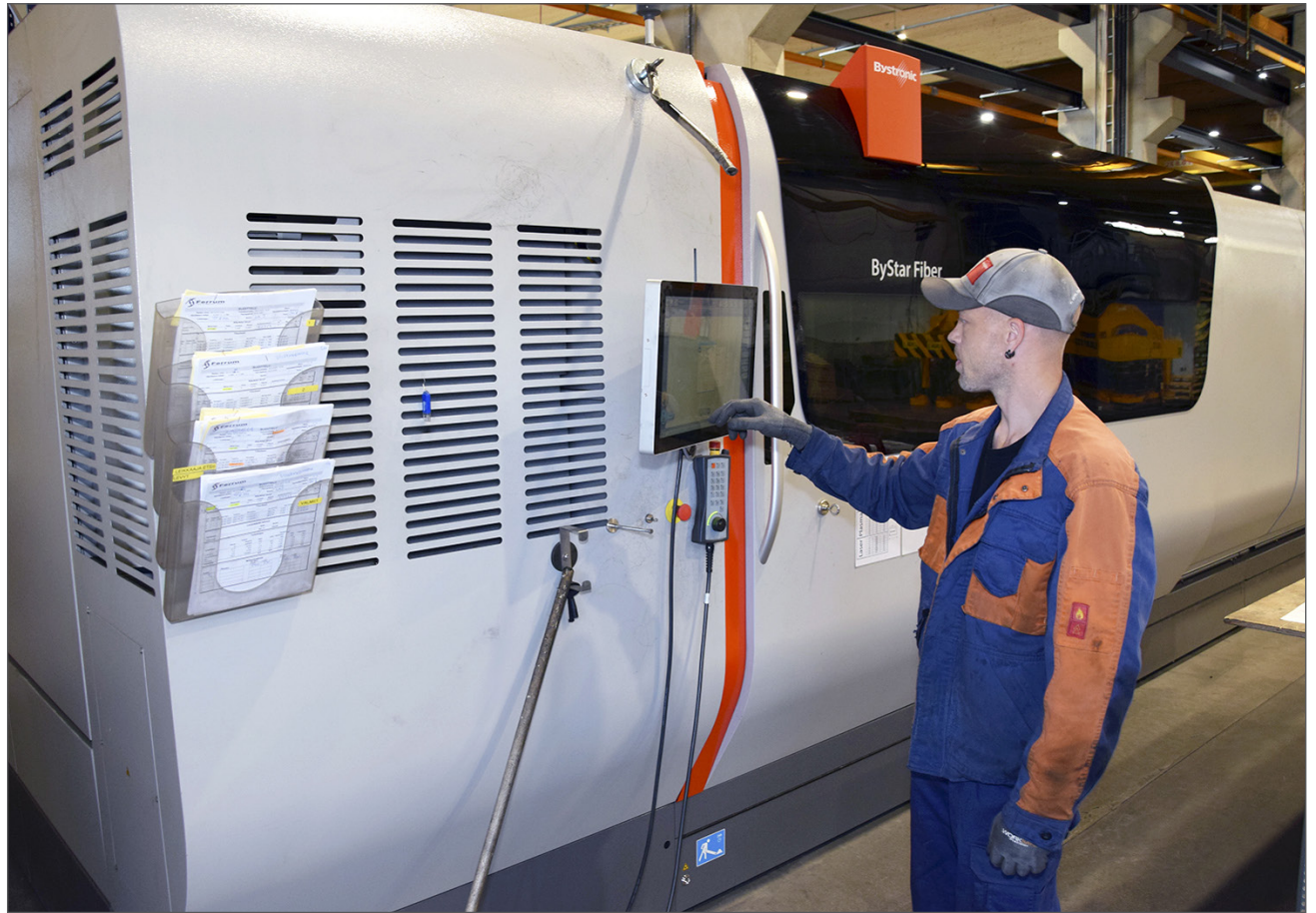
Bystar Fiber on Ferrum Steelin tuore kuitulaserinvestointi. Teho 12 kW, pöytäko 8000x2500 mm. Kuvassa Mikko Kärkkäinen.
