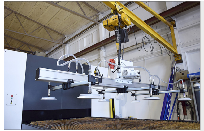
Työalue laserissa on 1500x3000mm. Nostin avustaa levynkäsittelyssä.
