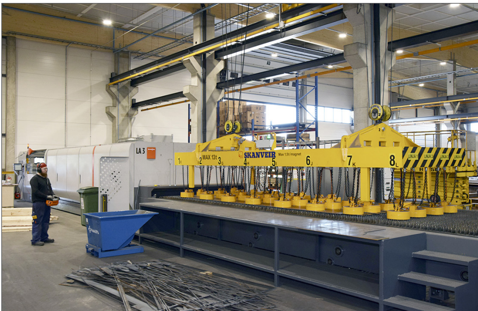
Kookas laser, kookas käsittelylaitteisto: tällä magneettinostimella liikkuvat teräslevyt vaihtopöydälle 13 tonnin painoihin saakka.
