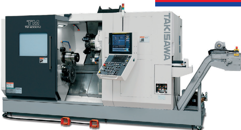
Takisawa TM4000-Y2, sorvauskeskus: vastakara, 2 x työkalurevolveri, 2 x Y-akseli, 2 x pyörivät työkalut
