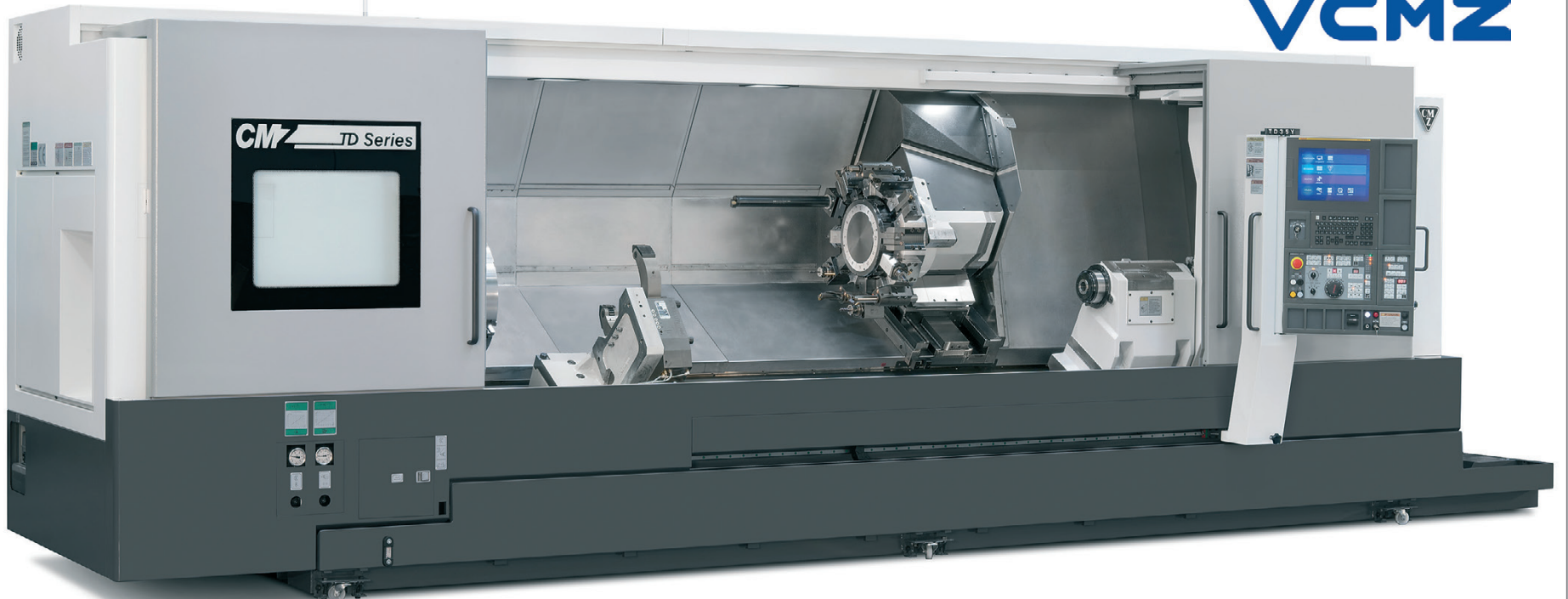
CMZ TD35-YT x 3200 Fanuc 32i-TB iHMI, vinojohteinen CNC-sorvi: sorvauspituus 3200 mm, Y-akseli, tehokkaat ja vääntävät pyörivät työkalut max. 13 kW / 105 Nm sekä ohjelmoitava mukana liikkuva tukilaakeri
