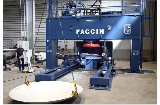
Kitakoko Faccinin PPM-sarjan puristimessa on viisi metriä, puristusvoimaa kone tarjoaa 300 tonnia.
