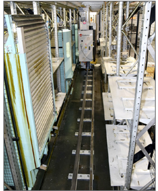
FMS-linjasto uusittiin samassa investointi-kokonaisuudessa. WCO (Work Cell Operations) tuo uusia ominaisuuksia mm. tuotannon suunnitteluun, ohjaukseen ja valvontaan.
