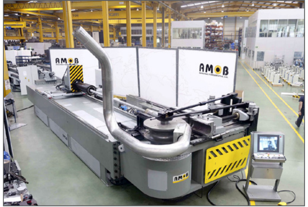
Järeitä CNC-putkentaivutuskoneita aina Ø 420 mm halkaisijaan asti. Maailman johtaviin kuuluvan valmistajan vahvuuksia on, että koneet, työkalut ja ohjelmistot valmistetaan hyvin pitkälle alusta loppuun itse.
