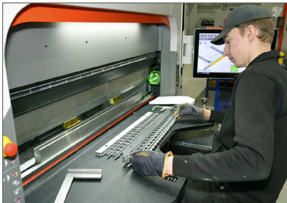
Kompakti särmäyspuristin on näppärä työasema pienten kappaleiden käsittelyyn. Taivutustöissä Elmeri Hakkarainen.
