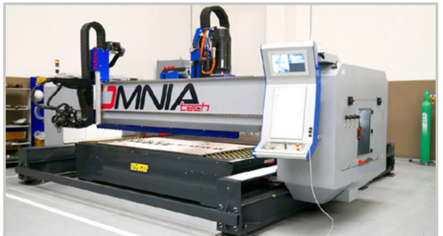
Soitaabin OMNIAtech voidaan varustaa eri teknologioilla, kuten plasmaleikkaus, kaasuleikkaus, viisteleikkaus, merkkäus, poraus, senkkaus sekä jysintä.
