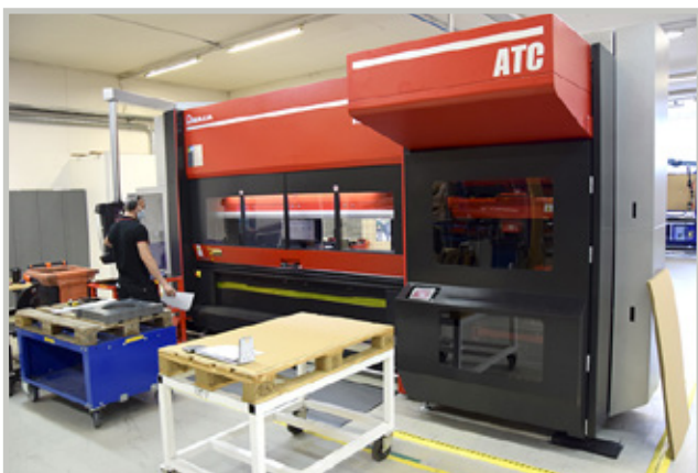
Automaattinen työkalunvaihtojärjestelmä lyhentää särmäyksen asetusajoja olennaisesti.
