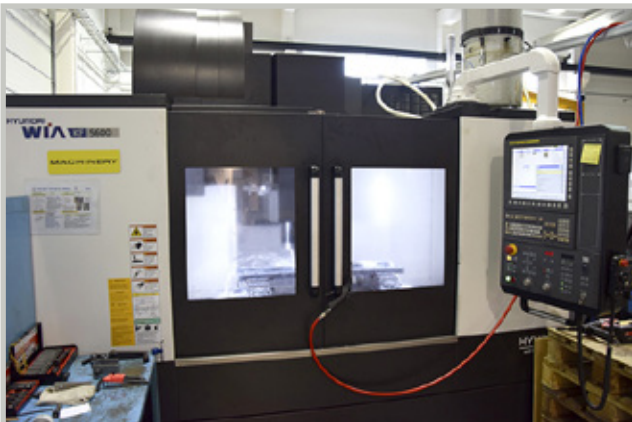
KF5600 edustaa Hyundai-Wian uutta tuotesarjaa. Suoraveto- tai built-in- kara, lineaarirullajohteet ja tukeva rakenne edistävät tarkkaa valmistusta.
