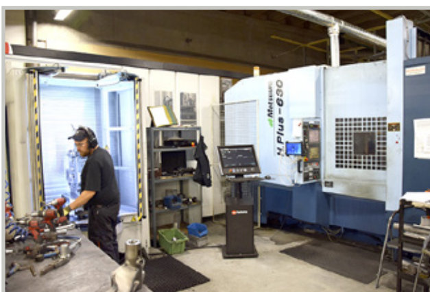
Parisen vuotta sitten 4-akselinen Matsuura-keskus automatisoitiin uudelleen Fastemsin FPC-konttijärjestelmällä.
