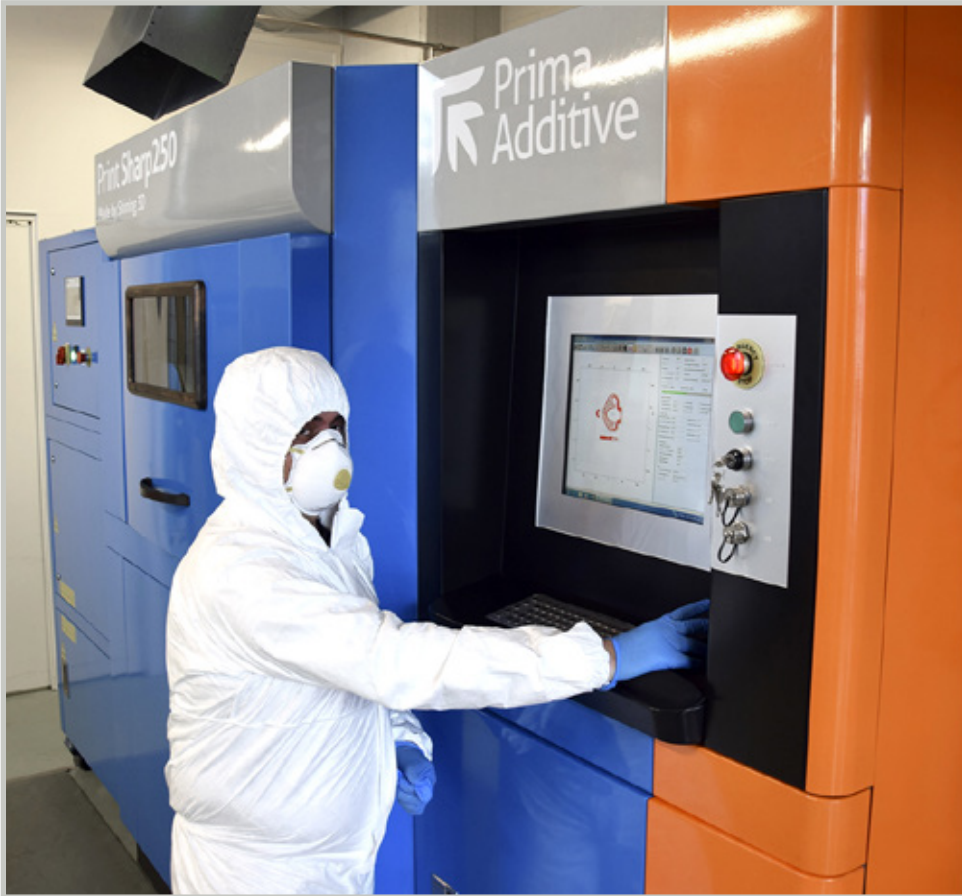
Uusi 3D-metallitulostin on ollut Technobotnian käytössä vuoden päivät. Tulostustyöt vaativat käyttäjältä kunnon suojauksen. Ohjauksella Sulaymon Tajudeen.
