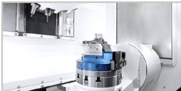
Vakiona on 15 000 kierroksen kara. Liikealue koneessa on 350 x 420 x 380 mm.
