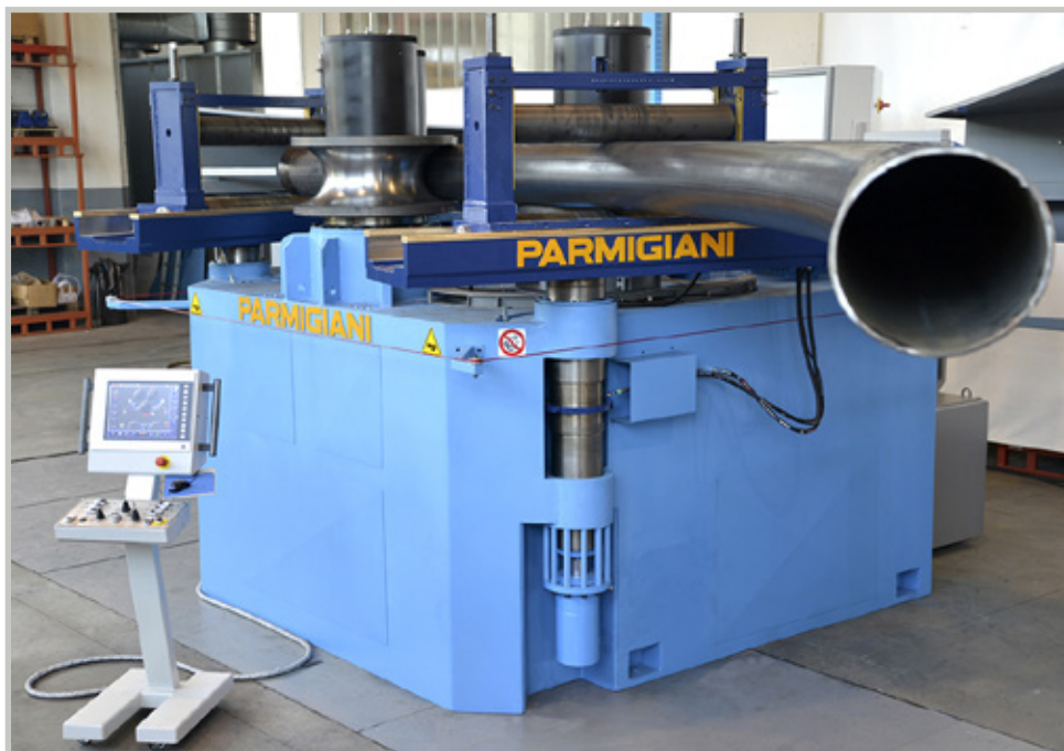
Horisontaalisesta tai pystyyn asennettavien Parmigianin rullataivutuskoneiden kapasiteetti alkaa "huonekaluputkista". Järeimmät taivuttavat yli 70-sentistä, 22-mm seinämäistä putkea.
