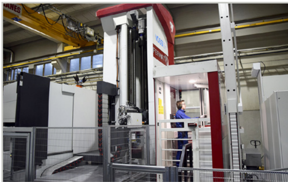
Robottityökalunvaihtaja on 125-paikkainen. Koneen ominaisuuksia ovat myös mm. 25 m/min pikaliikkeet mahdollistavat lineaarijohteet, 70 barin läpikarantähditys ja 5 kierrosta minuutissa pyörivä 1800x2200 mm pöytä sekä Fermat 0-pistekiinnitinjärjestelmä.
