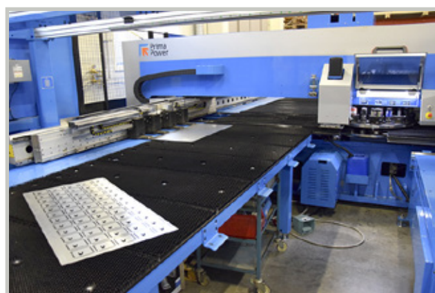
Yhdistelmä hoitaa leikkausten lisäksi samassa kokonaisuudessa levytyökeskuksen työt. Näin onnistuvat mm. lävistykset ja kierteitykset.
