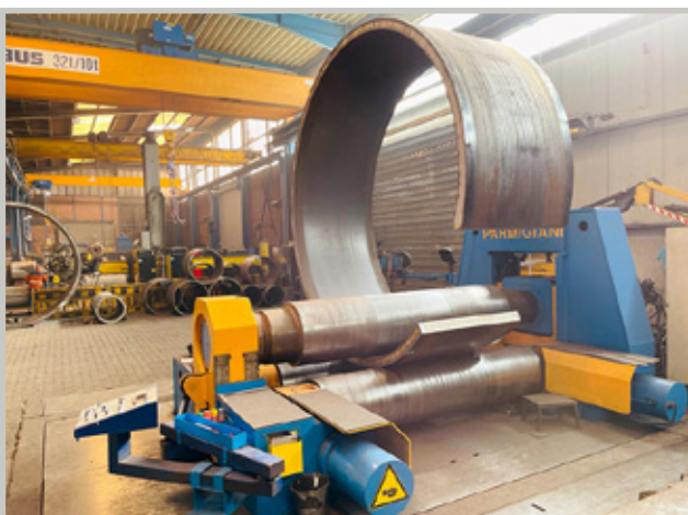
Parmigiani valmistaa 3- ja 4-telaisia levyntaivutuskoneita, jotka voidaan varustaa reaaliaikaisella taivutuksen seurannalla ja säädöllä hienosäätäviksi automaattisiksi taivutussoluiksi.
