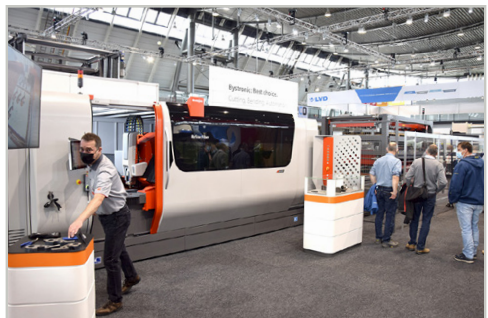
Bystronic on täydentänyt ByStar Fiberien tehovalikoimaa 15 kW:iin. Kone oli esillä messuilla varastojärjestelmällä automatisoituna. Myös esimerkiksi uusi ByTube Star 130-putkilaser esiteltiin, helppokäyttöinen kone mahdollistaa sujuvasti automaatioasetukset myös avoimille ja soikeille profiileille.
