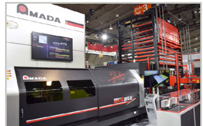
Amadan uutta tarjontaa messuilla edusti tornivarastolla varustettu mm. Ventis 3150 AJ-kuitulaser mukanaan korkealaatuisen ruostumattoman teräksen ja alumiinin leikkaamiseen mahdollistava, lasersäteen kuviota leikkausprosessin aikana muokkaava LBC-teknologia. Valmistajan Regius-3015 AJ esiteltiin messuilla 9 kW:n tehoin.
