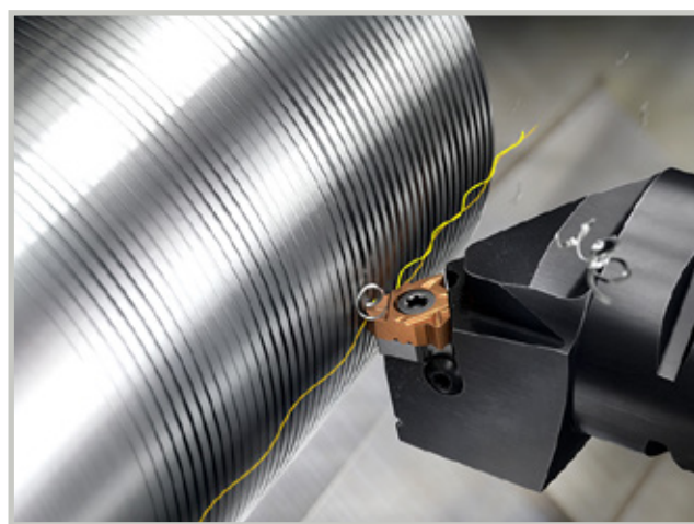
OptiThreading -ohjelmistomoduuli ratkoo uudella tavalla lastunhallinnan haasteita kierresorvauksessa.
