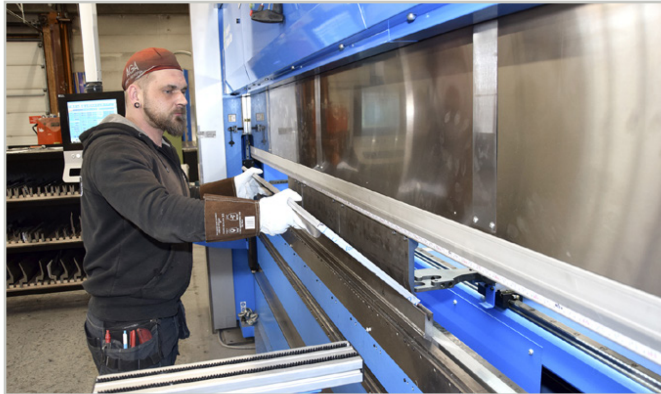
Uudenmaan RST tekee metallista mittatilaustöitä. Uusi sähköservotoiminen särmäyspuristin lisää kapasiteettia ja tuo tarkkuutta töihin. Särmäämässä Ali Tuononen.
