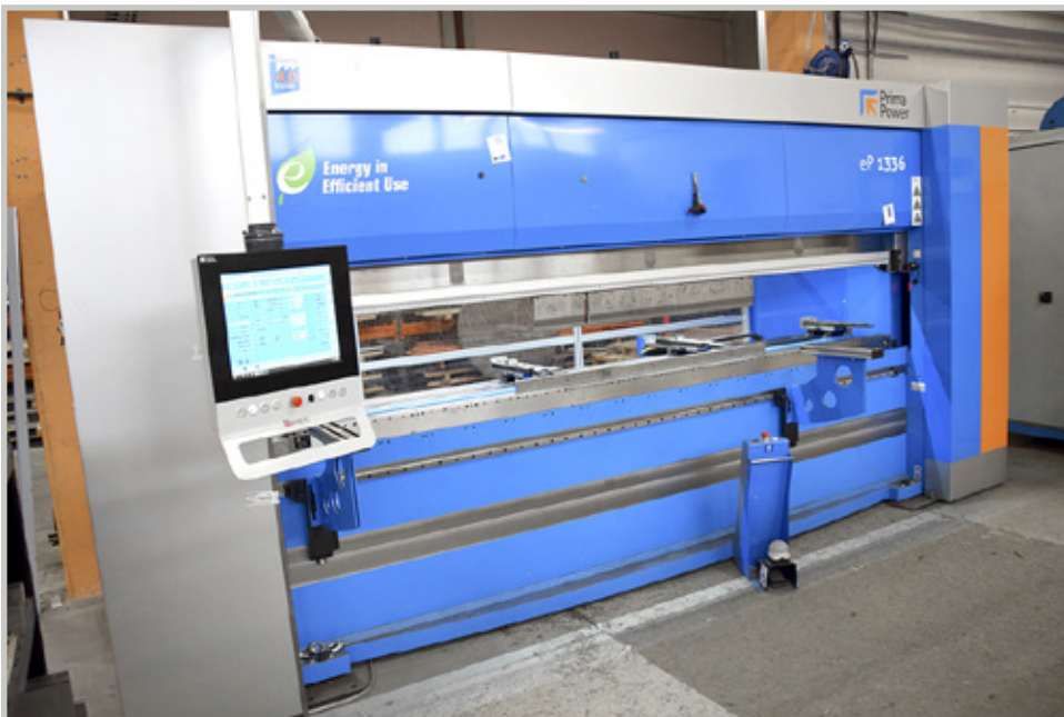
Taivutuslevyys eP 1336:ssä on 3600 mm. Puristusvoima on 135 tonnia.
