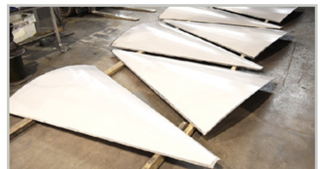
Vesilaitoksien rakennus- ja uudistustyöt ovat Tercolle keskeinen toimintasektori. Uusilla koneilla mahdollistuvat leikkaukset ja taivutukset kolmeen metriin saakka. Kuvassa vesihuoltolaitteiden kuoriosia.
