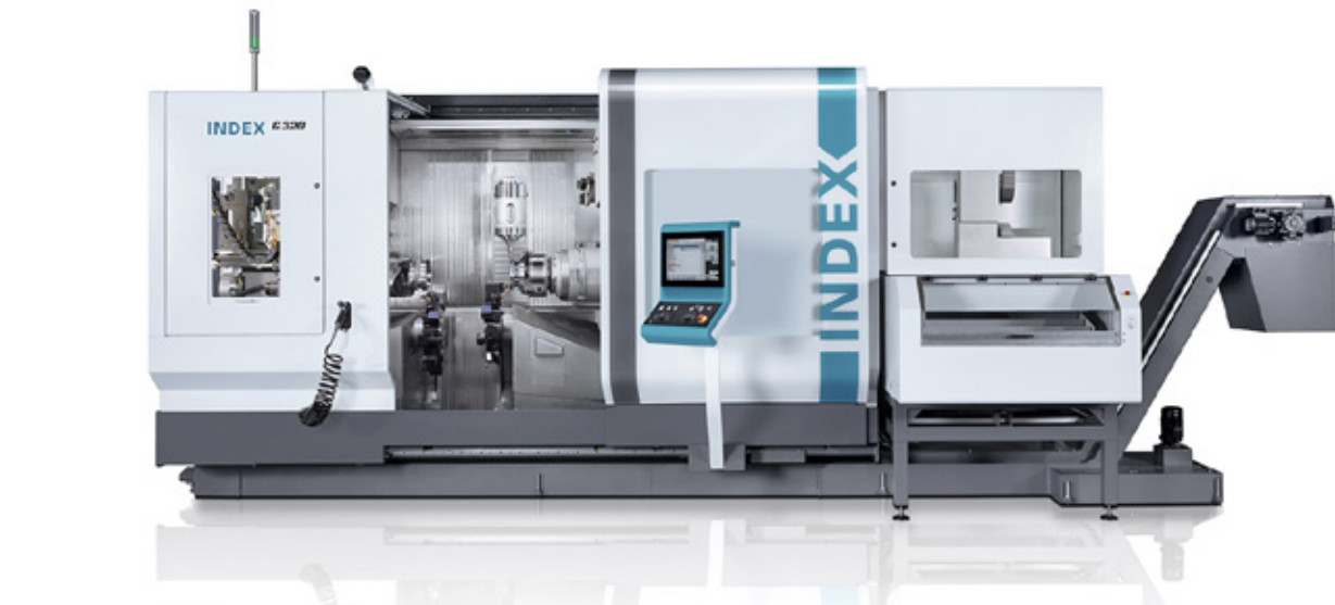
Index G320 on kaksirevolverinen uutuuskeskus sorvauksen ja jyrsintään. Kaksinkertaisella tarraimella varustetun portaaliuormaan lisäksi työkappaleen käsittely voidaan tehdä myös modulaarisen iXcenterin kautta.
