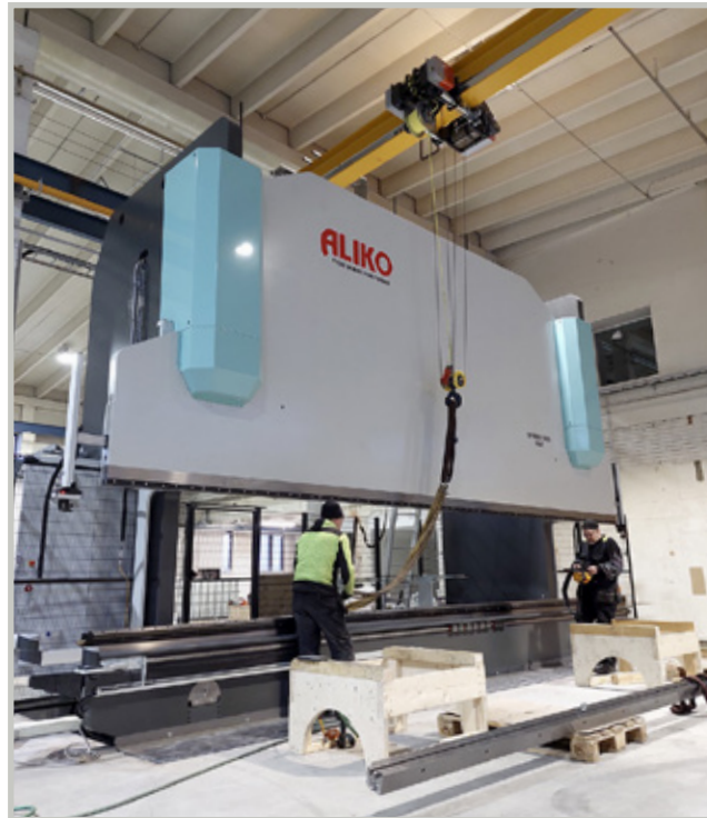
HT Laser on investoinut kaudella 2021-2022 tuotantonsa merkittävästi. Tuoreita investointeja ovat mm. laserleikkaukone (isossa kuvassa) Bystronic ByStar Fiber (12 kW, 4 m), särmäyspuristin (kuva yllä) Bystronic Xpert Pro 250/3100 ja (kuva vieressä) kookas särmäyspuristin Aliko Giant SP 8000-1000, minkä yhteyteen asennetaan jatkossa automatisoitu työkalujärjestelmä.
