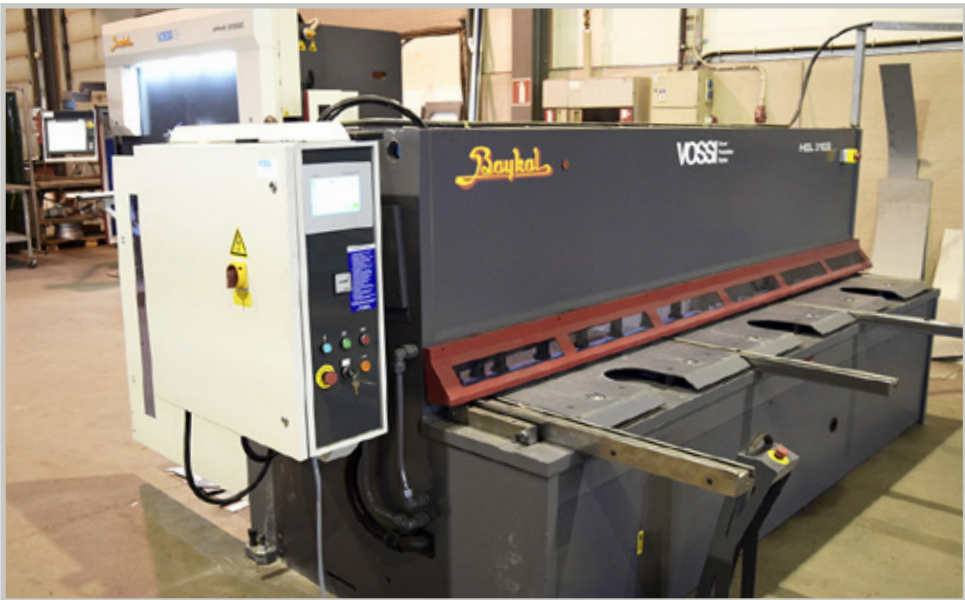
Baykal APHS 31200-särmäyspuristin ja etualalla oleva saman valmistajan HGL 31008 -levyleikkuri ovat talon uudet hankinnat.
