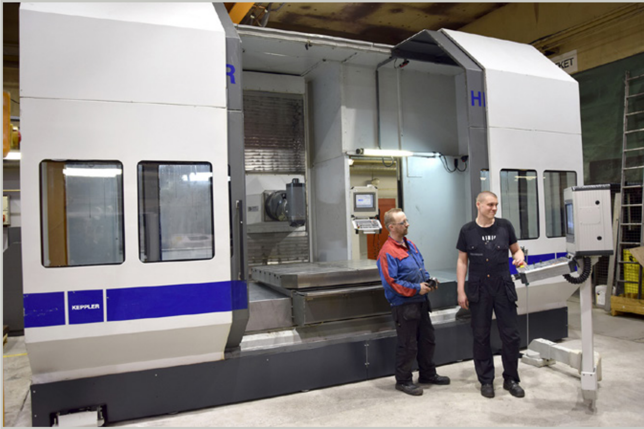
Kookasta teknologiaa projektina Nurmekseen. Keppler HDC 3000:n kuuden samanaikaisesti liikkuvan akselin myötä koneella voidaan koneistaa kappaleita viideltä sivulta samalla kiinnityksellä. Ohjauksella kuvassa Mikko Nevalainen (vasemmalla) ja Harri Juutinen.
