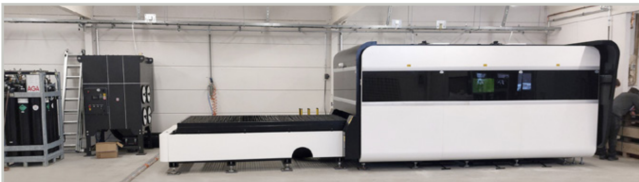
G-Weike-kokoonpanossa vasemmalta oikealle N2- ja O2-patterit, ilman puhdistava HEPA-suodatin, paletinvaihtaja ja itse G-Weike-laser. Koneen takana seinän vieressä on ohjauskaappi, IPG-laser, jäähdytyskoneikko ja jännitetasaa.
