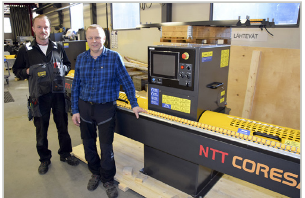
Yhtenä erikoisalueenaan NTT valmistaa kivenkäsittelykoneita pitkin perintein. Tutkimuskäyttöön suunniteltu ja toteutettu kivenkairauksen halkaisukone NTT Coresaw on patentoitu tuote mm. Pohjois-Amerikan markkinoille, toteavat Marko Kähkönen ja Mika Kähkönen.
