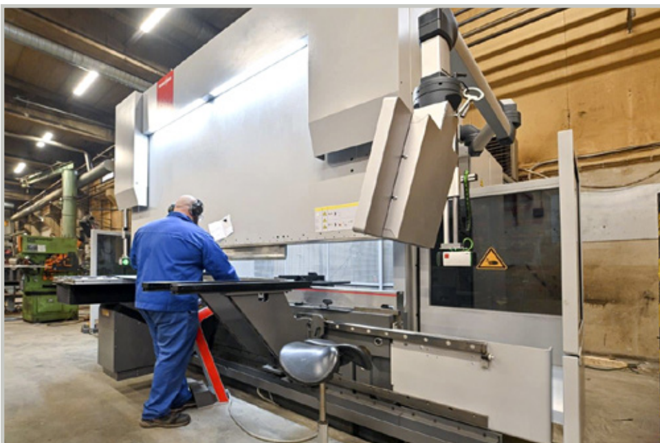
Puristusvoimaa koneessa on 400 tonnia ja taivutusleveys on 4 metriä.
