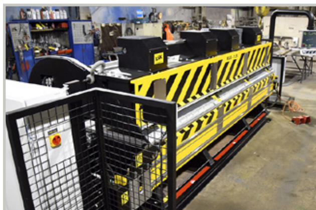
Uudistuksen myötä KST:n ohjaus on täysin uusittu, kone on nyt myös sähköhydraulinen.
