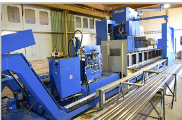
Pituusliike ulkomitoiltaan nelitoistametriseissä koneissa on 6200 mm.
