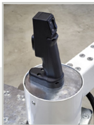
Koneenkäyttäjä ohjaa tornivaraston ja tarttujan toimintaa yhdestä pisteestä joystickin avulla.
