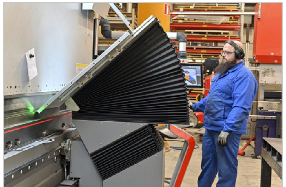
Kookkaiden ja raskaiden levyjen ja kappaleiden käsittelyssä etunostolaite tuo ergonomiaa ja mahdollistaa sen, että isojenkin kappaleiden käsittely hoituu yhdeltä koneenkäyttäjältä.
