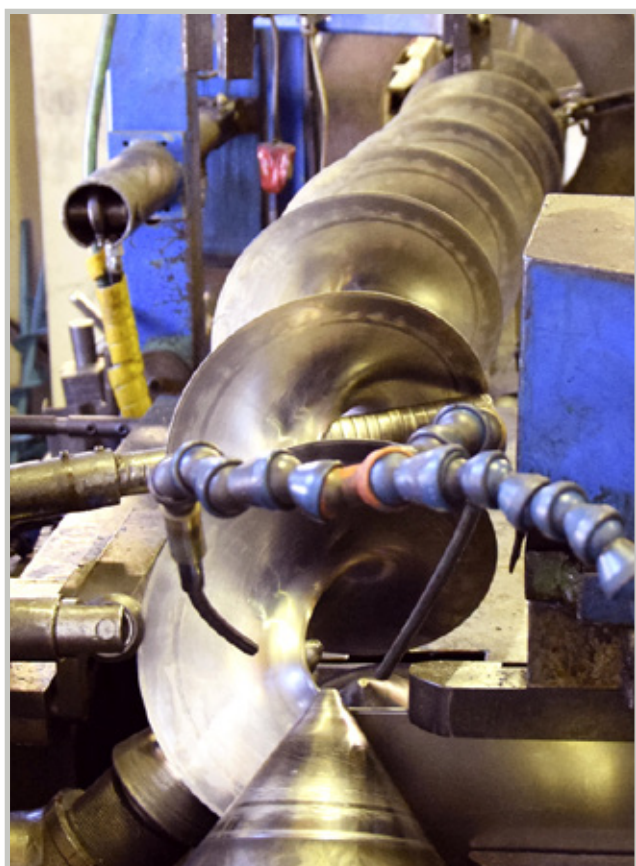
Kairatehtaan tuotantokalustoa. Kookas spiraalivalssi on yksi tehtaan keskeinen kone.
