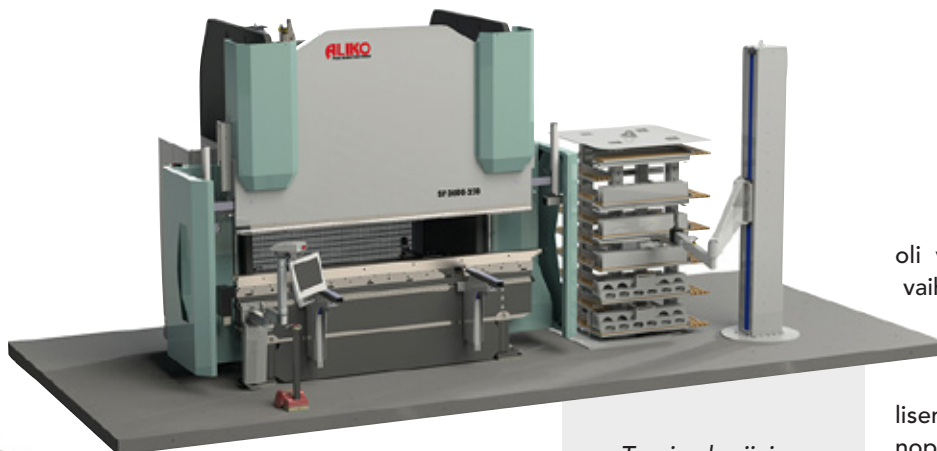
Tornimakasiinissa hyllyjen määrä on muokattavissa tarpeen mukaan, maksimikapasiteetti työkaluille rakenteessa on 2000 kiloa.
