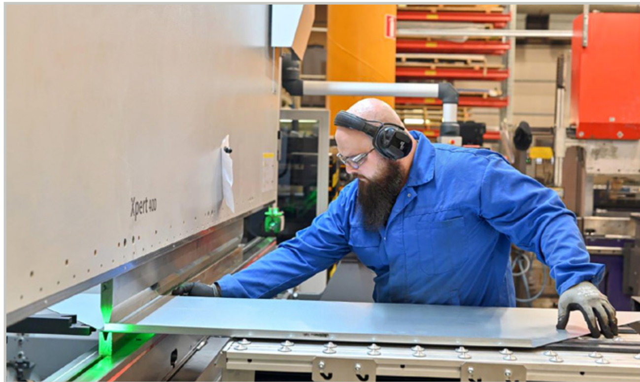
Omia tuotteita ja alihankintaa. Uuden särmäyspuristimen koko ja suorituskky lisäävät kapasiteettia Aimo Kortteen Konepajalla. Jori Gill särmää.
