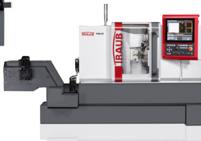
Uusi Traub TNL12 -automaattisorvi on helposti muunnettavissa perinteiseksi CNC-sorviksi.
