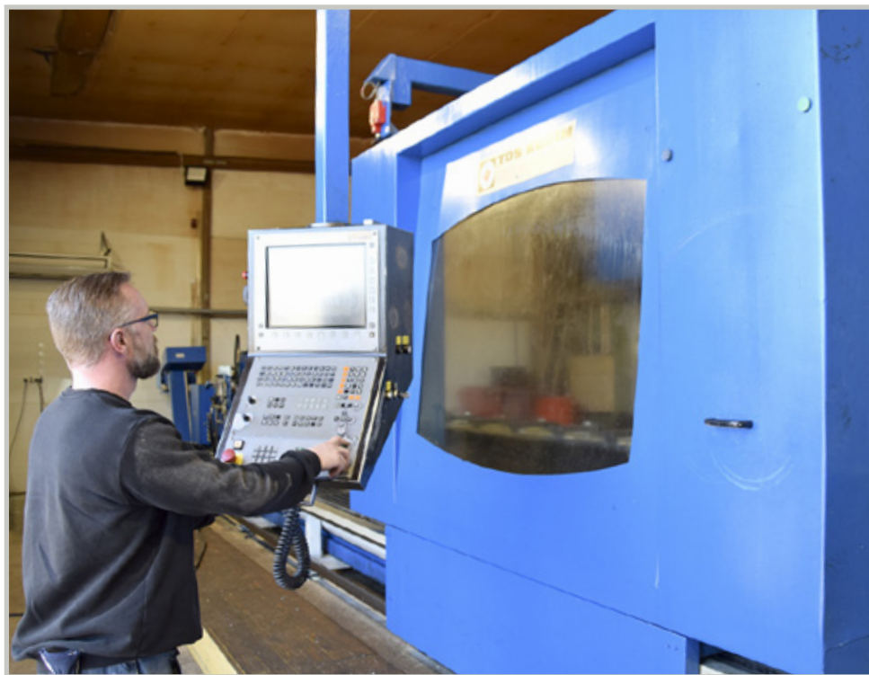
Kookas viisiakselinen TOS Kurim-pitkäjyrsinkone täydentää LSK-Machine koneistuskapasiteettia. Ohjauksella Simo Merola.
