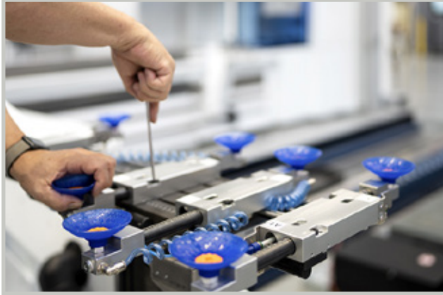
Trumpfin helposti asennettava gripper on uusi ratkaisu tehostamaan automatisoiduille taivutussolujen tuotantoa.
