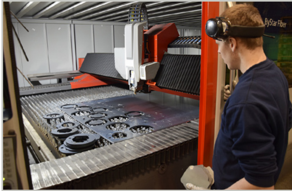
Ateno laserleikkaa yleensä enintään 25 mm:n vahvuuksia. Kuvassa levyvahvuus on 15 mm.
