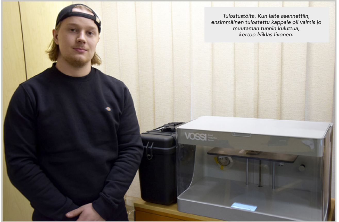
Sate Steelillä laitteella on tulostettu varsinkin robottitarttuvia ja työkaluja särmäyspuristimelle. Etualalla parissa tunnissa syntynyt ensimmäinen kappale, pieni siipiras.
