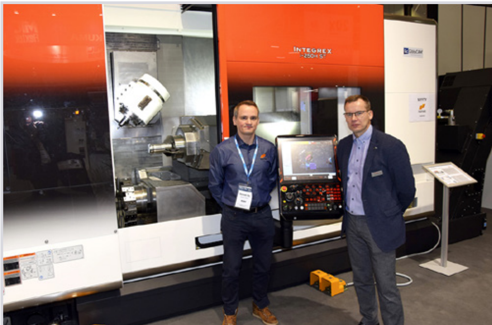
Mazak INTEGREX i-250H-ST -monitoimisorvi oli messuesittelyssä kahdella kahdeksan tuuman sorvauskaralla, 24 kW jyrsinkaralla, 74-paikkaisella työkalumakasiinilla ja 12-asemaisella kohtisuoralla sorvausarevolverilla sekä MAZATROL SmoothAi-ohjauksella varustettuna. Koneen uusi omistaja on Nomet, vasemmalla Nometin Markus Lintula, oikealla Wihurin Matti Ranta.
