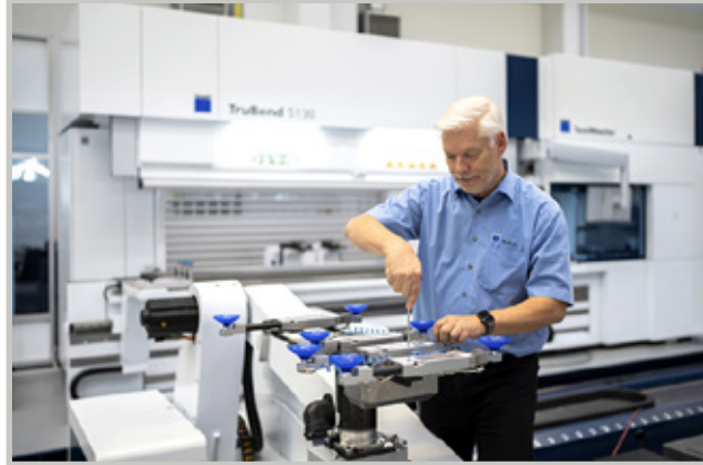
Trumpfin helposti asennettava gripper on uusi ratkaisu tehostamaan automatisoiduille taivutussolujen tuotantoa.
