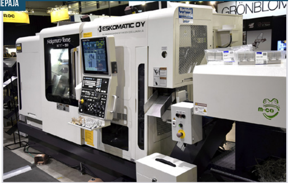
Insinööri-toimisto Ismo Lindbergin osastolla esillä oli mm. ajankohtaista ja talon päämerkkeihin kuuluvan Nakamura-Tomen konetarjontaa. Kuvan NTY3-150 on japanilaisvalmistajan uuden malliston kolmirevolverinen ja kolmella Y-akselilla varustettu monitoimisorvi. Se tekee jatkossa töitä Escmaticilla.
