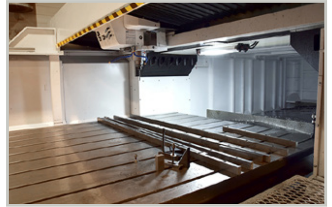
Portaali koneistuskeskus isolla työpöydällä varustettuna. X-liike koneessa on 4000 mm, Y- 2600 mm ja Z- 780 mm. Koneella tehdään mm. porauksia.
