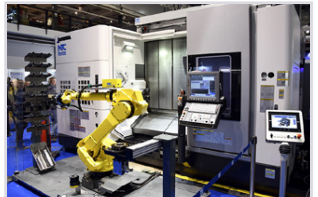
SMART production towards sustainability. MTC Flextek nosti messuteemanaan vastuullisuutta. Yhdessä Fastemsin kanssa operoidun osaston kookkain kone oli Okuma Multus U3000, min-kä yhteydessä esiteltiin automaattisen asetustenvaihtosolun toimintaa. Fastems demositi standilla mm. MMS 8-ohjelmaversiota.
