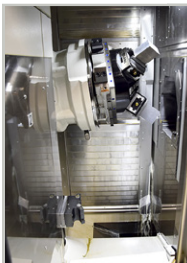
Omintakeisia piirteitä koneissa ovat pöytäratkaisu sekä Z-akselin liike tunneliin rungon sisään. Kuvassa työtilan alaosassa näkyvä lastunpoisto rungon läpi toteutettiin Salon Metalelektrolle räätälöitynä.
