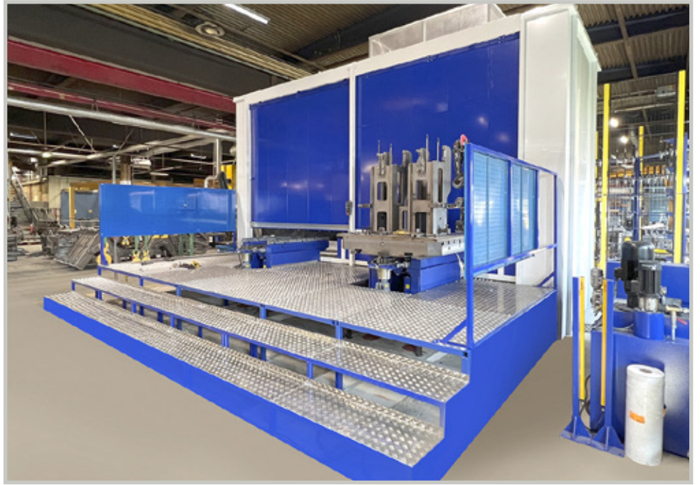
Uuden TOS WHN 130 MC avarruskoneen käyttö edellytti koneistajilta uutta osaamista ja ammattitaitoa.
