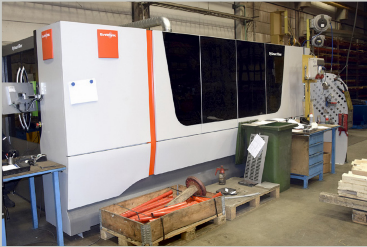
BySmart leikkaa 10 kW:n tehoin. Vahvuksissa päästään 30 mm:iin saakka.
