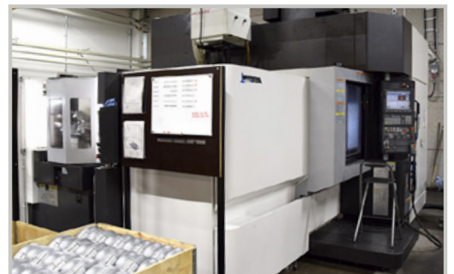
Nykykonekantaan Hyvinkäällä kuuluu mm. Okuman viisiakselinen MU-6300V. Korvaavat ja kapasiteettia lisäävät investoinnit ovat jatkossa suunnitelmassa.
