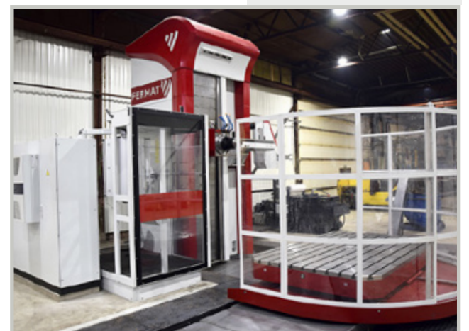
Vahva pöytä, kookkaat liikkeet. Uudessa Fermatissa maksimipaino pöydälle on 20 tonnia, X/Y/Z-liikkeet ovat 4000, 2500 ja 1500 mm.
