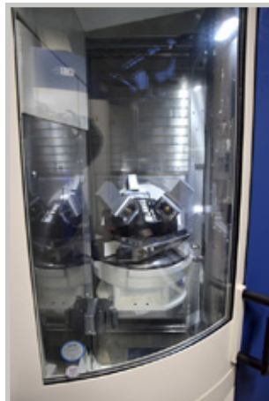
Salon Metalelektron tuore investointi on FMS-linjan täydellistä GROB-viisiakselikeskus, mihin linjan vaakakaraisten koneiden tapaan hankittiin Langin kiinnittimet. Perusidea ratkaisussa on, että yhdellä kiinnityksellä kappaleesta saadaan ajettua viisi sivua.
