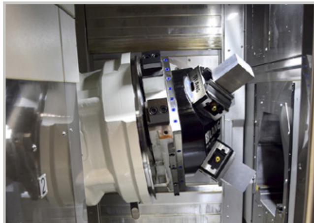
Salon Metalelektron tuore investointi on FMS-linjan täydellistä GROB-viisiakselikeskus, mihin linjan vaakakaraisten koneiden tapaan hankittiin Langin kiinnittimet. Perusidea ratkaisussa on, että yhdellä kiinnityksellä kappaleesta saadaan ajettua viisi sivua.
