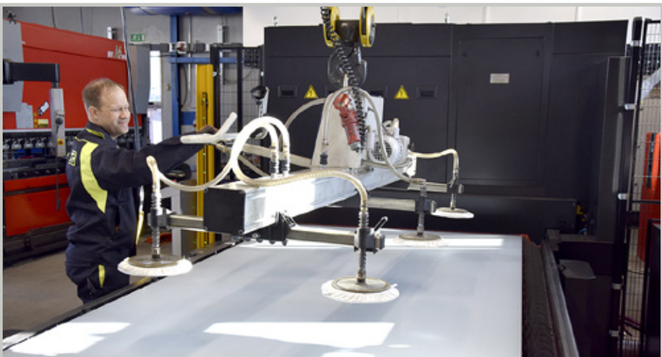
Nostolaite auttaa levynkäsittelyssä. Kone käsittelee 1500x3000mm: levyjä.
