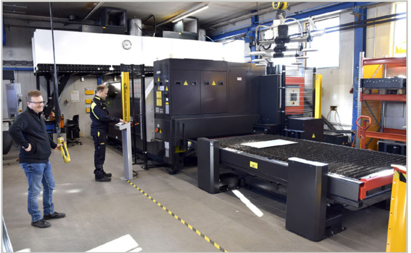
Amada Ventis AJ 3015 -tasokuitulaser on Il-Metin uusi konehankinta. Kompressorilaitteistot on Il-Metillä sijoitettu koneen yläpuolelle. Vasemmalla Marko Paus, levynostossa Mika Paus.
