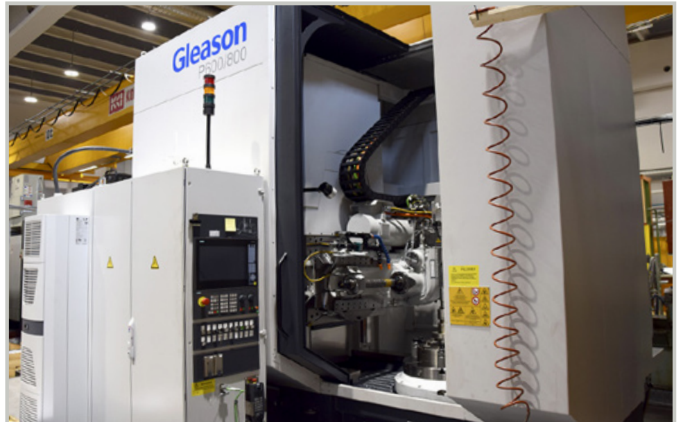
Gleason P600/800 on uusi vierintäjyrsinkone 1000 mm:n Z-liikkeellä.
