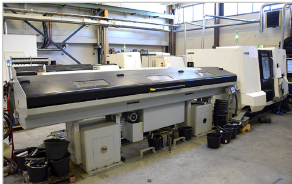
Kaksi konetta rinnakkain. Tankosyöttölaitteet molemmissa automatisoivat tuotantoa.
