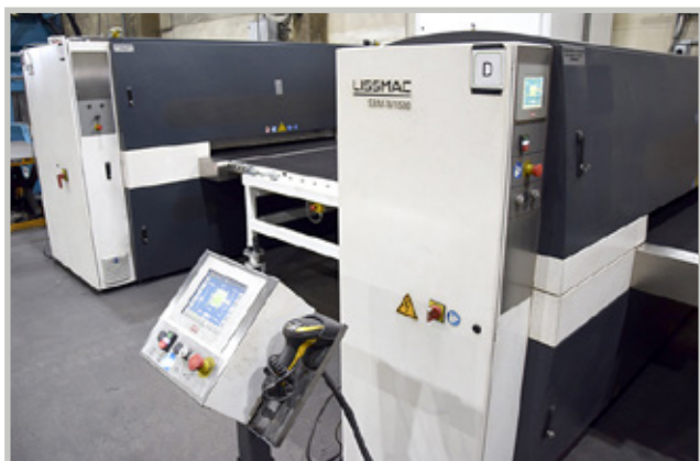
Linjalla mahdollistuu leveydeltään max. 1500 mm:n kappaleiden käsittely 100 mm:n vahvuuksiin saakka.
