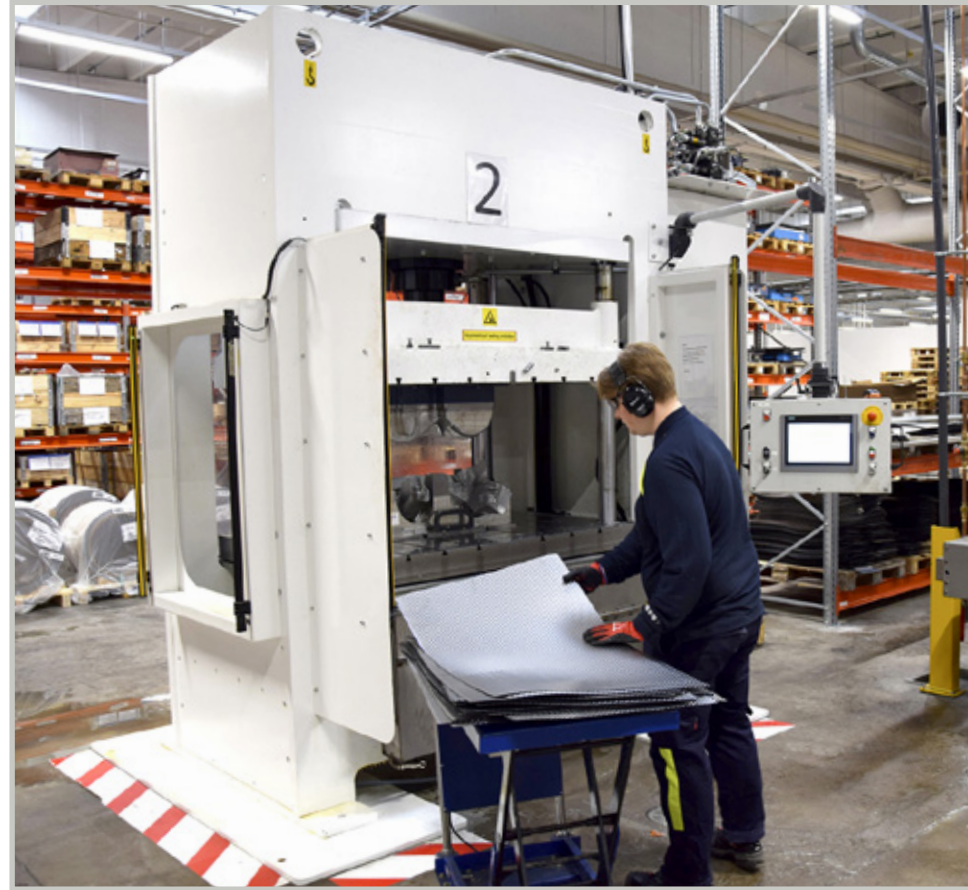
Lämpöeristetuotantoa Proventialla Oulussa. Levyt muotoillaan puristimella.
