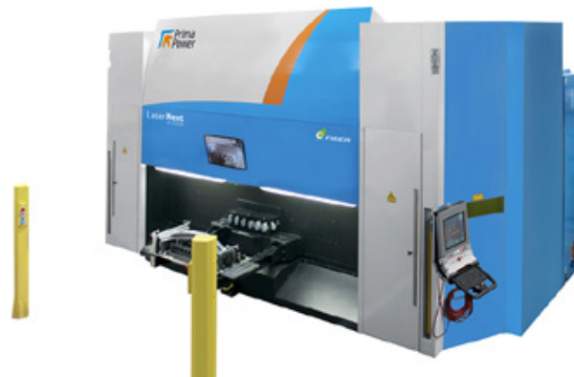
Laser Next on nopea 3D-laserkone mm. autoteollisuutta palveleviin tarpeisiin. Proventian mallissa työalue on X 3050 mm Y 1530 mm.
