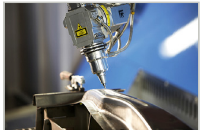
Proventialla lämpösuojat viimeistellään eli osat rajataan muotoonsa leikkaamalla. Laserin 3D-leikkauspää mahdollistaa moninaiset muodot.
