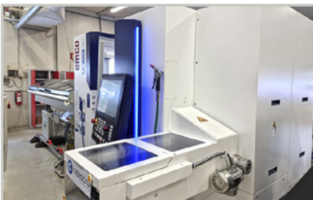
Automaattisen tuotannon mahdollistaa koneen yhteydessä Top Automazioni X-Files Multilevel -tankomakasiini, kappalepoimuri ja kuljetin.
