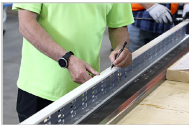
Linjalla valmistetaan ns. kaapelikouruja eli levyhyllyjä, niiden kulmakappaleita ja kiinnitysosia.
