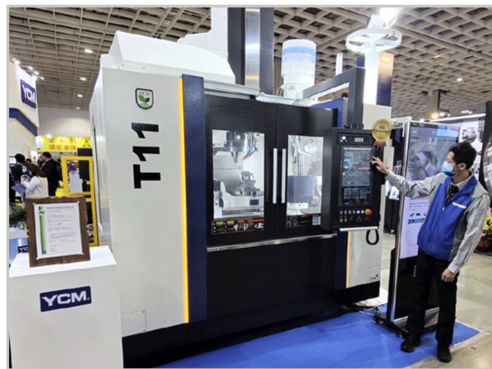
T-koneistuskeskussarja on YCM:n uutta tarjontaa. Viisiakselisissa T 11-mallissa X/Y/Z-liikkeet ovat 500/600/550 mm, A/C +120° ~ -120° / 360°.
