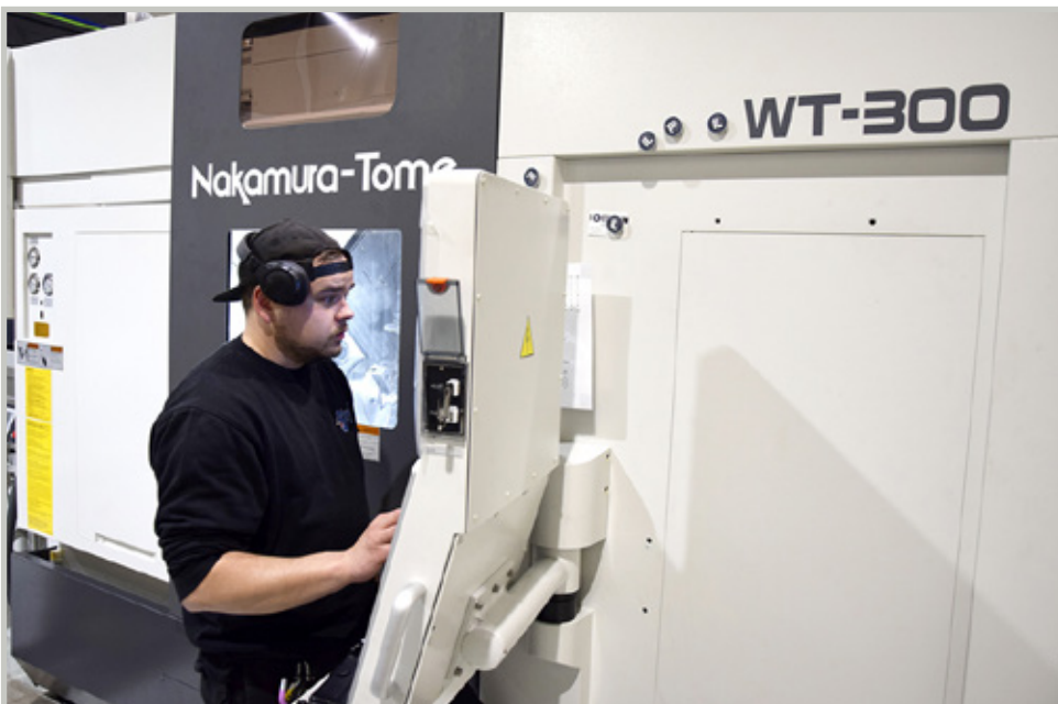
Kaksi karaa, kaksi revolveria ja Y-akseli mahdollistavat vaativan koneistuksen. Koneen käyttäjä Mikko Viljanen
