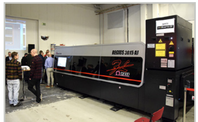
REGIUS AJ-malleissa mukana on useita erilaisia avainteknologioita, kuten älykäs leikkupään hallintajärjestelmä, Laser Integration -järjestelmä ja Variable Beam Control.
