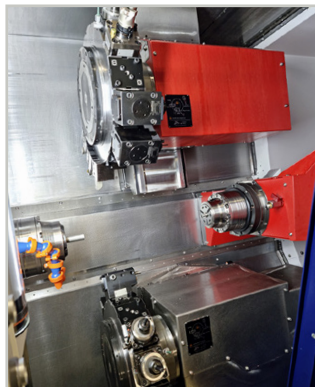
Molemmat karat on varustettu integroiduilla karamoottoreilla, joissa on tarkkuutta edistävä vesijäähdytys. Kaksi revolveria ovat 16-paikkaisia ja varustettu pyörivillä työkaluilla (12 000 1/min, 20kW ja 8 Nm). Y-akselin liike on +/- 40 mm.
