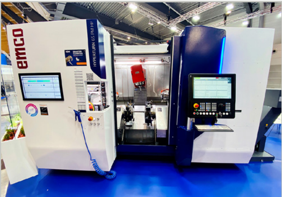
Itävaltalaisen EMCO esittelee mm. High Performance -version HYPERTURN 65 POWERMILL jysinkarallisesta monitoimisovista, jossa on vesijäähdytteiset integroidut pää- ja vastakaramootorit 29 (37) kW / 250 (360) Nm / 5 000 1/min / Ø 65 (76, 95) mm. Jysinkaran (12 000 1/min, 22 kW, HSK-T63) Y-akseli +120/-100 mm ja B-akseli +/- 110 °. Kaksi BMT55P-alarevolveria, joissa yhteensä 24 kpl pyörivien työkalujen paikkaa (30/20 Nm ja 10/8 kW) sekä Y-akselit +/- 50 mm. Työkalumakasiinissa 40 tai 80 työkalua. SIEMENS Sinumerik ONE -ohjaus.
