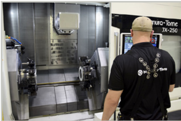
Kone on japanilaisvalmistajan uusi monitoimisorvimalli kahdella karalla, yläpuolisella jyrsinpäällä ja työkalumakasiinilla sekä kahdella alapuolisella, pyörivillä työkaluilla ja Y-akselin varustetulla työkalurevolverilla.
