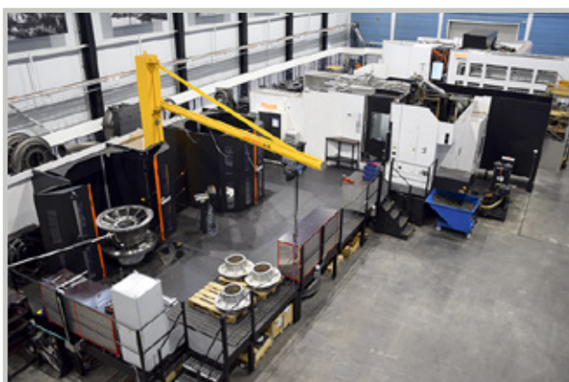
5-akselinen pystymonitoimisori Mazak Integrex e-1600V/10, vaakakarainen HCN10800II -koneistuskeskus ja 16-palettinainen Palletech muodostavat talon ensimmäisen automaatiojärjestelmän.
