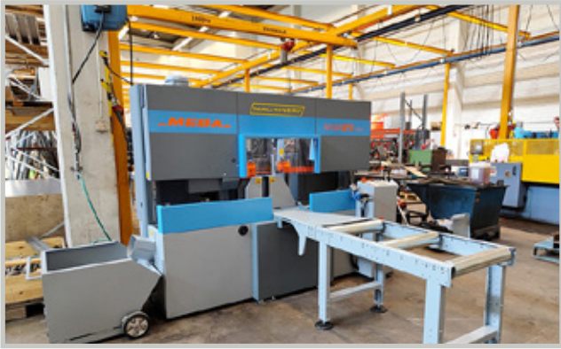
PTH-Metalli investoi kerralla kahteen Meba-vannesahaan: MebaPro 300-A automaattinen ja tehokas suorakatkaisu vannesaha sekä astekulmiin kääntyvä MebaSwing 260 DG-Hs puoliautomaattivannesaha.
