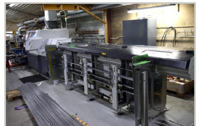
Uusi pitkäsorvausautomaatti saapui yrityksen käyttöön viime syksynä. Koneella koneistetaan pieniä ja pitkiä osia esimerkiksi hienomekaniikkaan tai lääketieteen alueelle.
