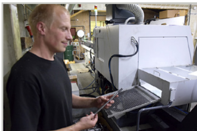
Pitkät ja ohuet kappaleet ovat optimaalisia pitkäsorvausautomaatilla koneistettaviksi.
