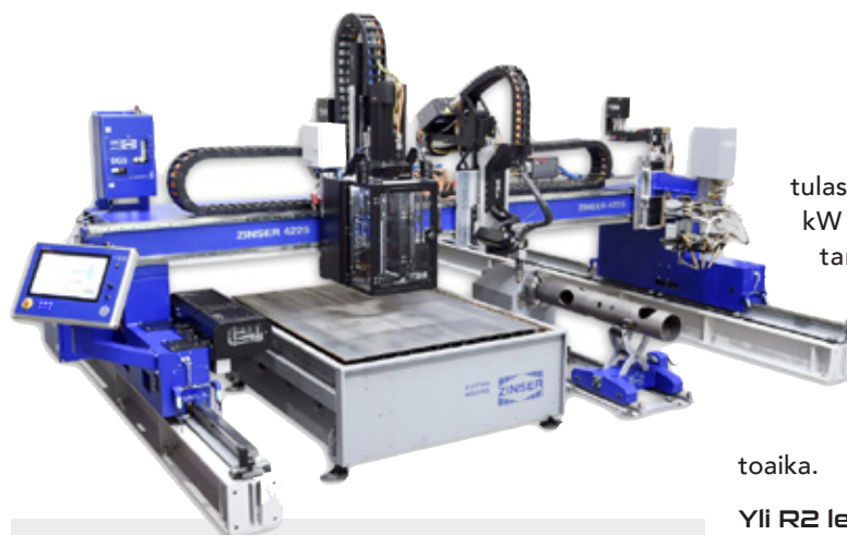
Vossin perinteisillä Kilpailuetupäivillä on Suomen ensiesittelyssä saksalaisen Zinserin 3D-plasma- ja kaasuleikkauskone, jossa on mm. tehokkaat jyrskykyvykkydet sekä poraus- ja kierteytyskapasiteetit aina ø 40 mm (100 mm levyyn) asti.
