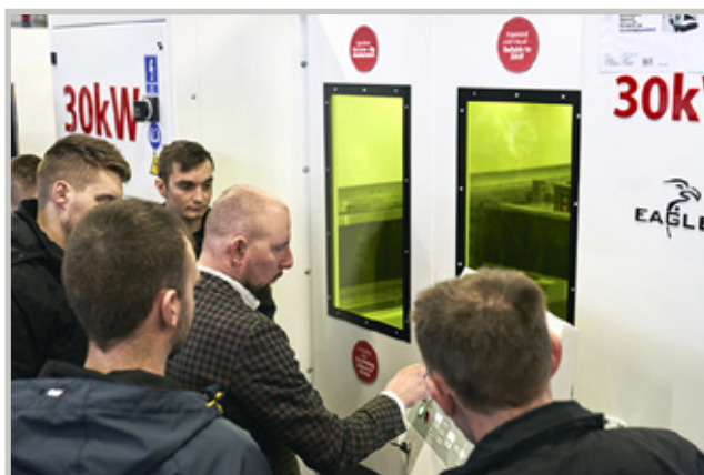
Esittelyssä olevassa Eagle iNspire tasokuitulaserissa yhdistyy 30 kW tehon mahdollistama äärimmäinen lävistys- ja leikkausnopeus, 6G kiihtyvyys sekä 9 sekunnin pöydänvaihtoaika.
