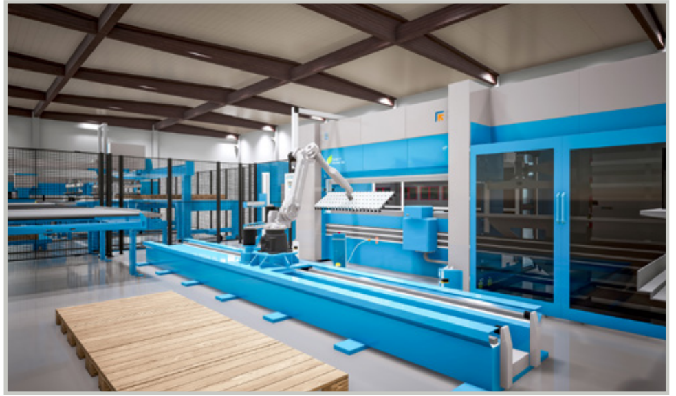
Järjestelmään kuuluvan eP Geniuksen yhteydessä toimii teollisuusrobotti miehittämättömiä lastaus- ja purkuoperaatioita varten.
