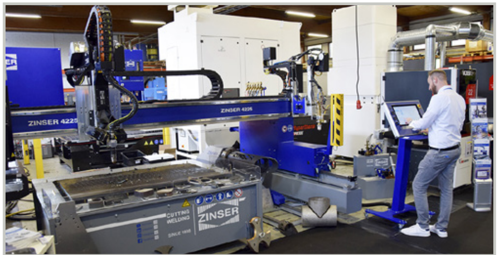
Zinserin 3D-plasma- ja kaasuleikkaukseen nähtiin Kilpailuetupäivillä Suomen ensiesittelyssä. Koneessa on poikkeuksellisen tehokkaat jyrsin- ja porausominaisuudet (max. ø 40 mm 100 mm levyyn). 3D-viisteleikkauksessa Zinser pystyy käyttämään kaikkia akseleita yhtäaikaaisesti. Lisäksi plasma- ja kaasuleikkauksen ainutlaatuinen pikavaihto mahdollistaa erittäin joustavan työskentelyn.
