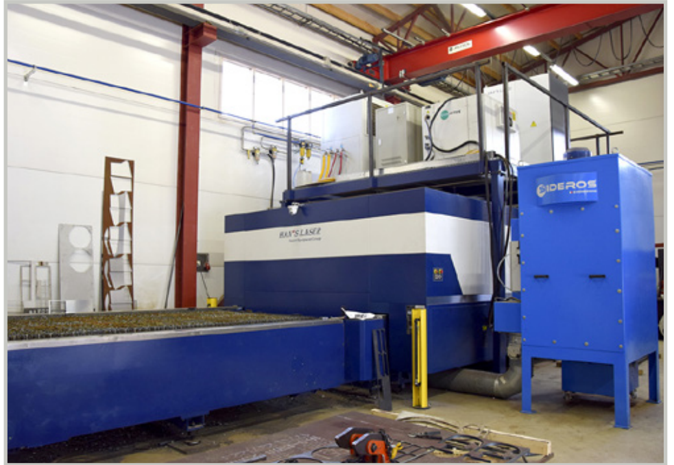
Kompressorit ja ilmapuhdistuslaitteet sijaitsevat kätevästi koneen katolla. Hallinosturi avustaa materiaalinkäsittelyssä.
