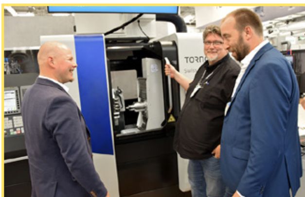
Uutuus esittelyssä. Tornosin yhdeksänakselinen, tankokapasiteetiltaan 32 mm:n Swiss XT 32 esiteltiin maailmanuutuutena messuilla. Koneen piirteisiin tutustuvat kuvassa Raikka Oy:n konepajan tuotantopäällikkö Ari Katajamäki ja myyntipäällikkö Niko Rautavuori. Makrumin Ismo Hyttinen esitteli konetta.
