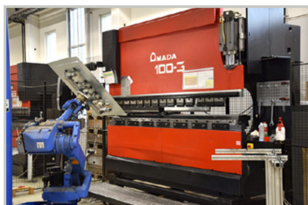
Särmäyspuristimia on Premecin käytössä myös lataustoimintojensa osalta robotisoituna.
