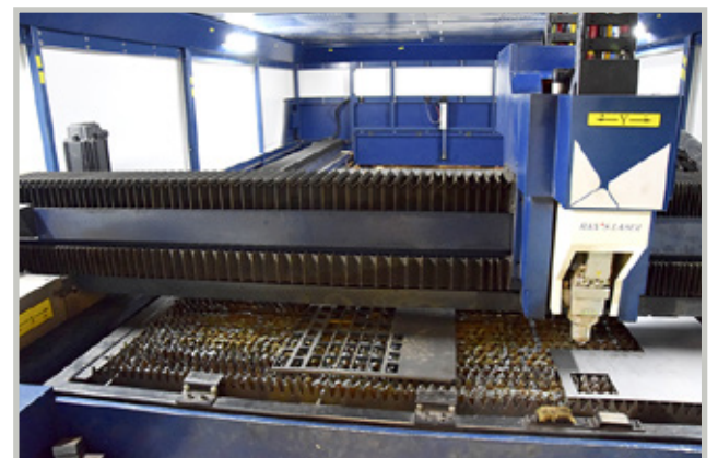
Työaluetta. Koneella voidaan käsitellä 2x4 metrin levyjä. 12 kW:n leikkausteho mahdollistaa sujuvasti paksumpienkin levyjen leikkaamisen.
