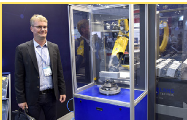
Langin osastolla oli esillä mm. valmistajan RoboTrex-automaatiota tarkkaan 0-pistekiinnitykseen. Vakiomallit ovat RoboTrex 52 ja 96. Mallissa 52 on 77 mm leveä puristin ja paikkoja 60 kpl solua kohti, 96:ssa 125 mm leveä ja 30 paikkaa. Robotit 20 kg ja 50 kg kapasiteetilla. Vierellä Nurminen Toolsin Sami Hellsten.
