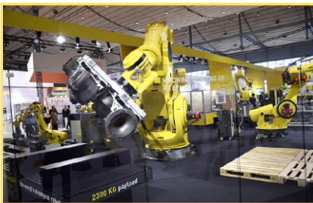
Robotteja riitti messuilla joka lähtöön, mutta tässä niistä isoin. "Maailman vahvin robotti" -teemalla liikkui Fanucin osastolla malli Mi2000/2300. Kuten tunnus kertoo, robotti pystyy nostamaan maksimissaan jopa 2300 kg:n kappaleita. Kookas valukokonaisuus liikkui robotilla suluavien liikkein.
