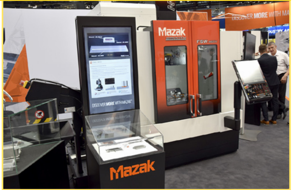
Mazakin messuosastolla juhlittiin mm. valmistajan INTEGREX-monitoimisorvisarjan 40-vuotista taivalta. Automaatiojärjestelmiä esiteltiin ja uusia konemalleja. Kuvassa yksi mielenkiintoinen uutuusmalli, automatisoidun kitkahitsauksen ja lastuavan työstön samaan kokonaisuuteen yhdistävä hybridikone FSW-460V mm. sähköautojen valmistuksen ja akkuteollisuuden kasvaville markkinoille.
