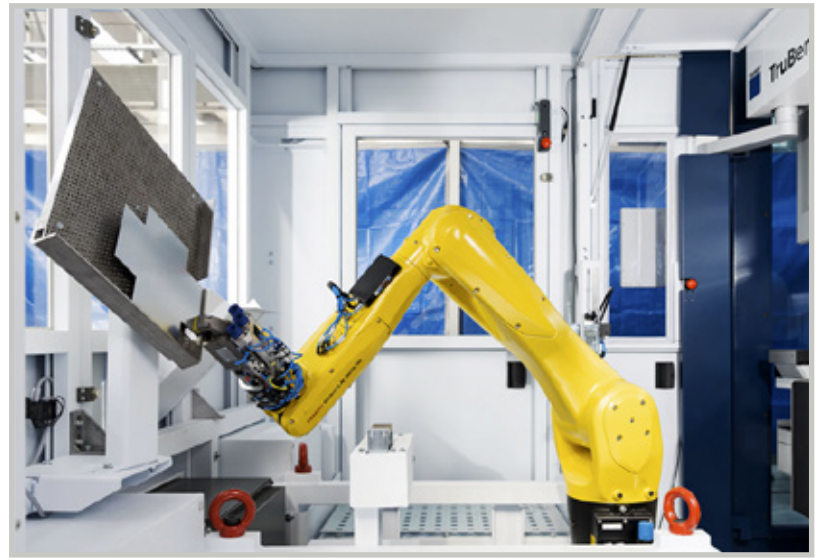
Solussa teollisuusrobotti lastaa ja purkaa TruBend 7050:n itsenäisesti.
