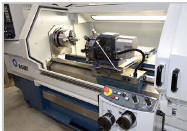
Pyörähdys- halkaisija johteilla on 520 mm ja kärkiväli on 1500 mm. Kone- tta voidaan ohjata vaihtoehtoisesti myös käsiohjauksella.
