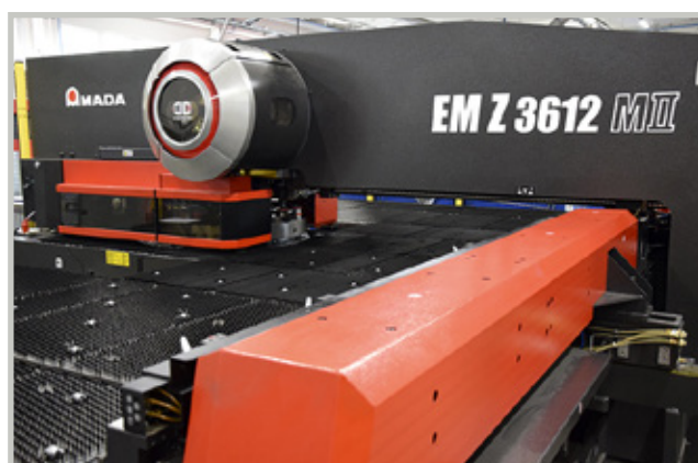
Uusi EM Z 3612 MII on Amadan toisen sukupolven EM-sarjan kone TWIN-servotekniikalla ja Z-revolverilla varustettuna.
