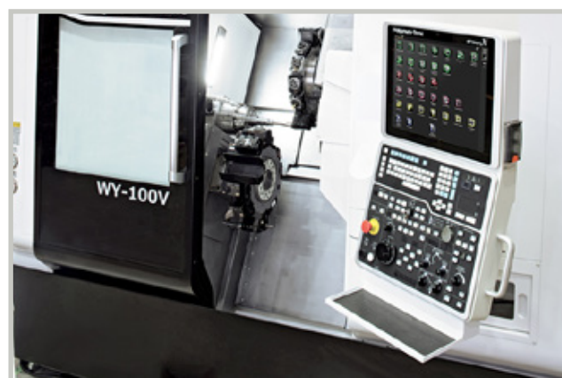
Nakamura-Tome WY-100V. Pääkaralla käynnissä messukappaleen koneistus.
