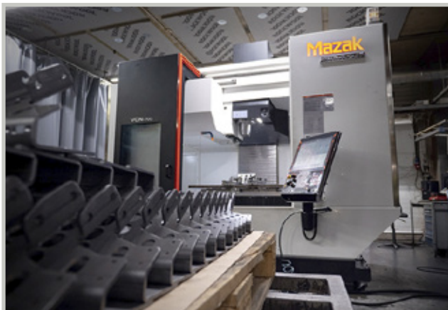
Mazak VCN-700 on uuden sukupolven pystykarainen koneistuskeskus. Korkean suorituskyvyn koneessa on entistä laajemmalla liikealueella.
