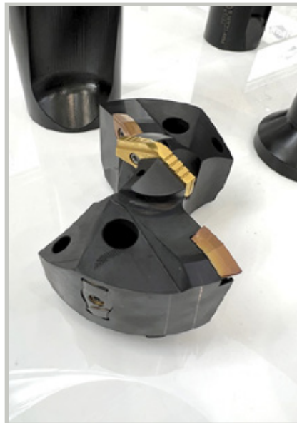
Alliedin tuotemerkki Wohlhaupter esitteli messuilla uuden kehitysversion digitaalisesta näyttömoduulistaan sekä siihen sopivan säätökasetin. Esillä oli myös mm. Amecin APX vaihtokärkipora isojen reikien poraukseen (33mm-150mm) myös haastaville nikkeli-, koboltti- ja duplex-seosmateriaaleille.
