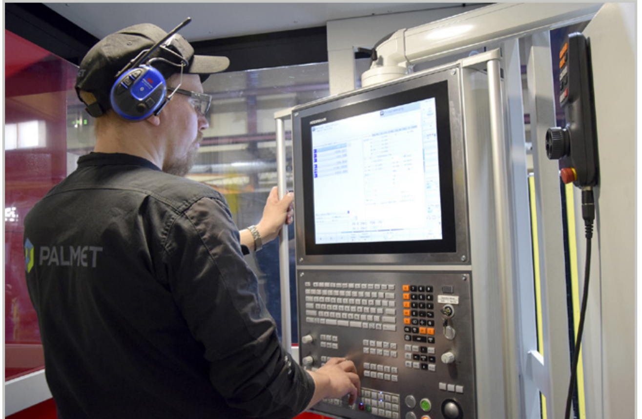
Nykyohjaus mahdollistaa sujuvat työt. Koneita ohjataan Heidenhain TNC 640 CNC-ohjauksella.
