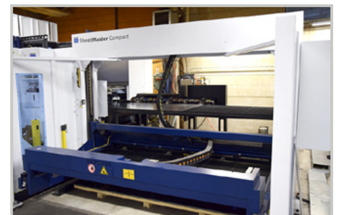
Sheet Master Compact on apuna levyjen automaattiseen lataukseen ja purkuun sekä aihoiden ja jättemateriaalien siirtoon.
