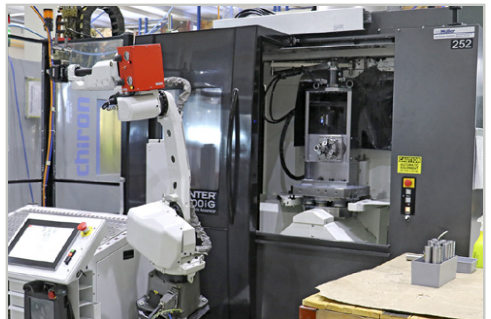
Vaihtopöydän ja automaattisen robottijärjestelmän ansiosta Kitamura/pL Lehmann-järjestelmä sopii taloudelliseen 24/7-käyttöön.
