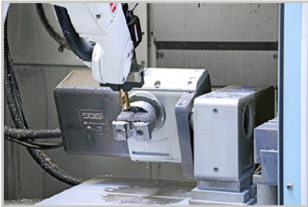
Nopea ja asemointitarkka: Kaksiakselinen kääntöpöytä TF-510510.LL varioX-Y1, valmistaja pL Lehmann, komponentin Brother BAZ TC-22B-0 päällä sopii optimaalisesti monimutkaisten osien kuten esim. sulkusylin- terien työstöön. Werder on automatisoinut tämän työstön robotin avulla.
