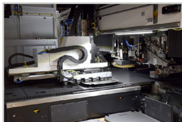
Materiaalivahvuus koneella on enimmillään 6,4 mm, lävistyksessä nopeudeksi tehdas ilmoittaa 600 1/min. Laserteho koneen TruDisk-laserissa on 3 kW.
