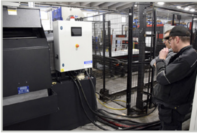
Leikkuunesteen suodatusjärjestelmästä on etua mm. alumiineja tai muoveja ajettaessa.
