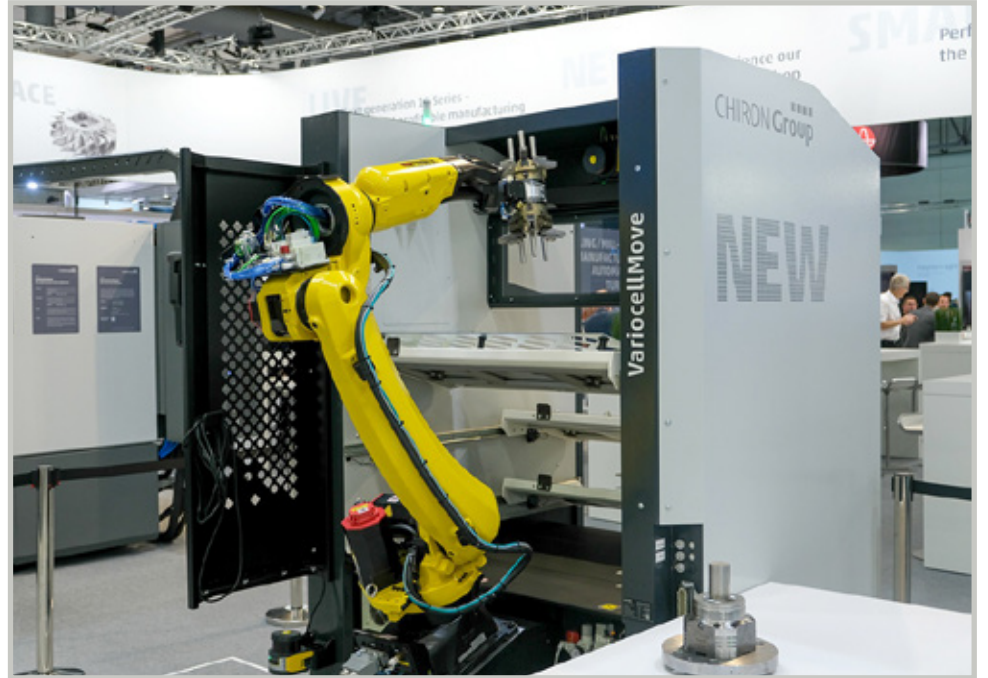
VariocellMove on älykkääseen työkalupaleen käsittelyyn tarkoitettu kompakti robottisolu.
