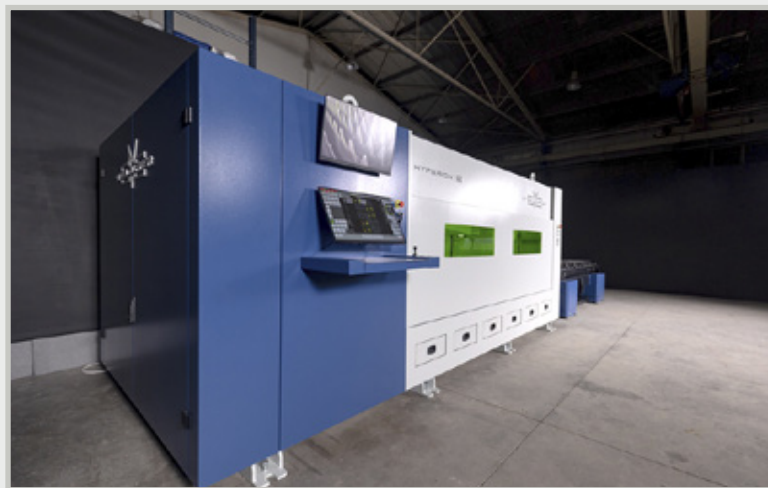
Hyperion E on kustannustehokkaaksi suunniteltu laserleikkauskonesarja. Lasertehoa on max. 4 kW ja enimmäisleikkuuvahvuus 20 mm.
