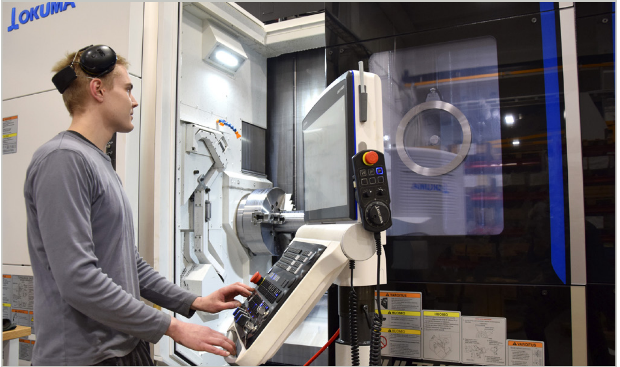
Monitoimisorvi mahdollistaa monet operaatiot kappaletta välillä irrottamatta. Koneistajana Arttu Syvänperä.
