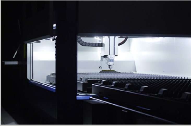
Boschert-Steelburner Hyperion Q -koneissa lasertehoa on tarjolla 30 kW sekä leikkuuvahvuutta aina 60 mm saakka.
