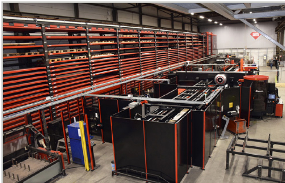
Kookas kokonaisuus. Amada EML 2515 AJ PDC -yhdistelmäkone korvaa aiempaa levytyökeskusteknologiaa Antti-Teollisuuden CS-tuotantolinjalla Kuusjoella.
