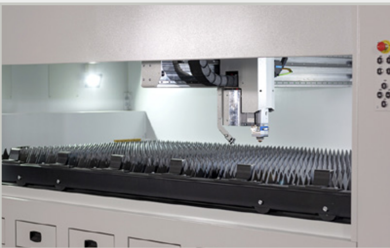
Hyperion E on kustannustehokkaaksi suunniteltu laserleikkauskonesarja. Lasertehoa on max. 4 kW ja enimmäisleikkuuvahvuus 20 mm.
