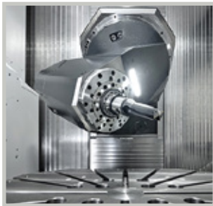
Hellerin erityisesti kehittämät uudelleen suunnitellut kääntöpäät integroiduilla moottorikaroilla lisäävät F 6000:n tarkkuutta ja dynamiikkaa.
