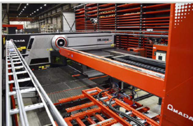
Yhdistelmä mahdollistaa levyjen leikkauksen, lävistys- ja muokausoperaatiot sujuvasti yhdessä kokonaisuudessa. Työalueen koko on 3050x1525 mm.
