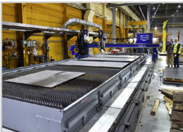
Kone lisää Staironin kapasiteettia ja korvaa aiemmin alihankinnasta ostettua työtä. Pöytäkoko koneessa on 3000 x 18000 mm.
