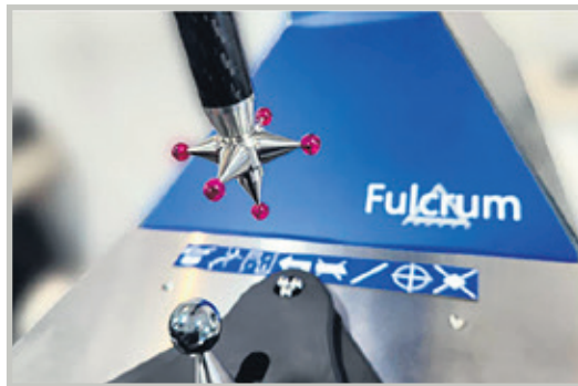
Fulcrum 3D-mittauspää sekä mittauspiirteiden yksinkertainen ja nopea valinta.
