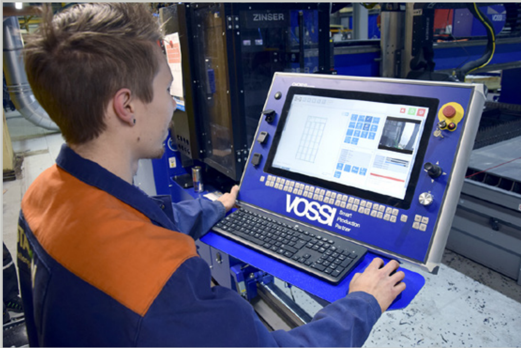
Staironin järjestelmä leikkaa, jyrsii, poraa ja kierteyttää tehokkaasti. Ohjauksella Aki Raappana.
