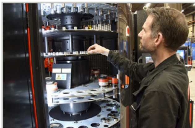
Koneen yhteyteen hankittu työkaluvaihtautomaatti laajentaa työkalupaikkojen määrää ja helpottaa raskaiden työkalujen käsittelyä.
