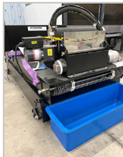
Dormatecin ilmansuodatinlaitteistossa on useita suodattimia, joiden vaihtotarpeen voi havaita hyvin näkyvillä olevista painemittareista. Putkistot ovat järeitä ja kovaa käyttöä kestäviä. Jäähdytysnesteelle on oma liikuteltava suodatinlaitteistonsa, johon on rakennettu riittävä kapasiteetti palvelemaan juuri kyseistä projektia.
