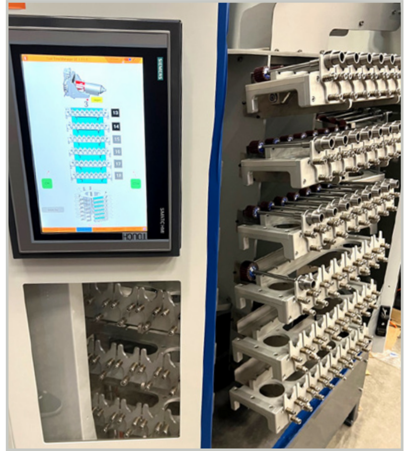
Senior Robotics Engineer Jaakko Tenhunen Flexmilliltä ja tuoteryhmäpäällikkö Kai Myrskog Dormatecin erikoisvalmisteen öljysumusuodattimen edustalla. Työkalut voidaan ladata ennakoon robotille vaihtoa varten ja keskeytyksettömän tuotannon varmistamiseksi. Laitteisto ohjelmistoinen on Flexmillin itse suunnittelema.
