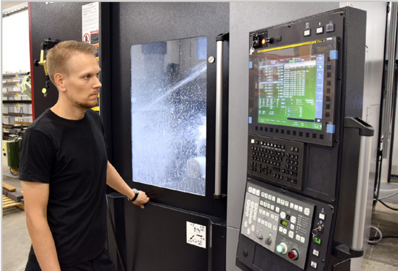
Nidec OKK VB-X650 on uusi tehokas paketti Kangasalan Kopalin viisiakselisiin töihin. Niko Korhonen asettui kuvaan koneen viereen.
