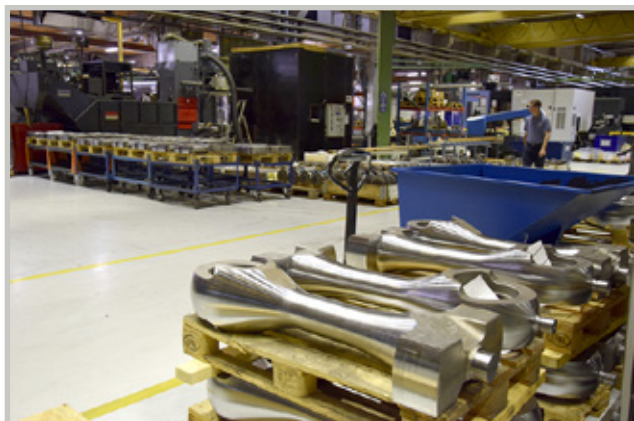
Kookkaita komponentteja. Purso-Tools on maailmalla johtava raskaiden nokka-akselien valmistaja. Lisäksi yrityksellä on vahva asema mm. raskaiden kiertokankien ja muiden vaativien koneosien valmistuksessa.
