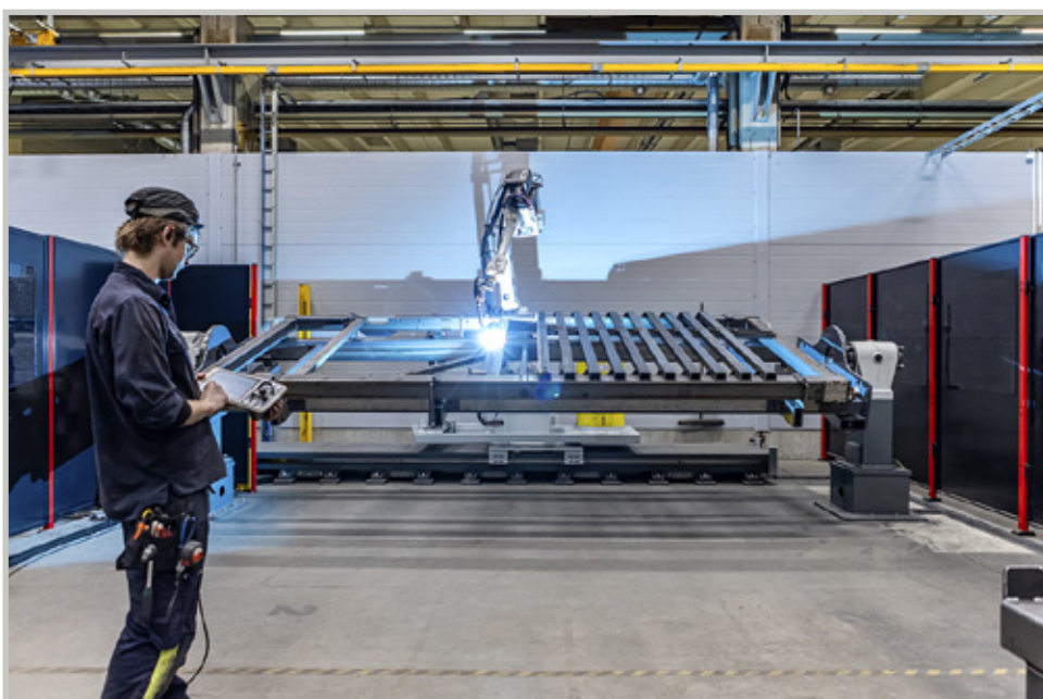
Tehtaan uusi hitsausrobotisolu käsittelee ja hitsaa kätevästi suuria esineitä, kuten koneen runkoja.
