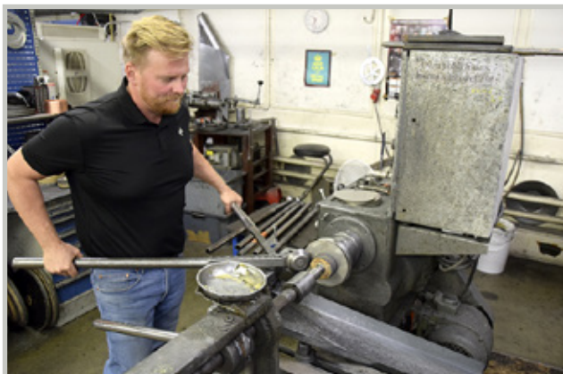
Perinteistä valmistusta. Erikoistöihin käytössä on yhä useita manuaalitoimisia painosorveja.
