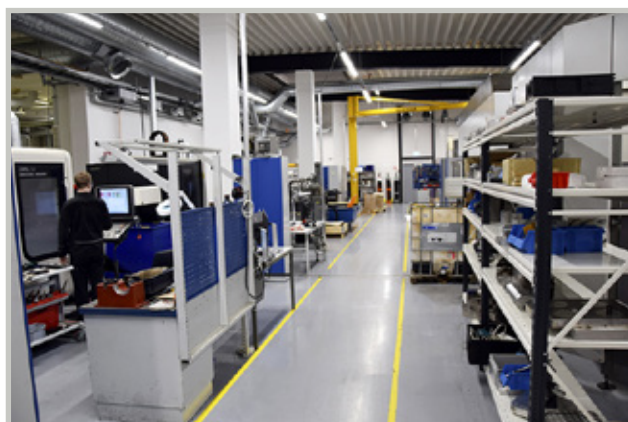
Mectalentin tilat Oulussa ovat noin 6000 neliömetrin suuruiset. Toimenkuvaan kuuluvat mm. koneistukset, erilaiset hitsaukset, lankakipinä- ja uppokipinätyöstö, mittaukset ja testaukset ja kokoonpanot.
