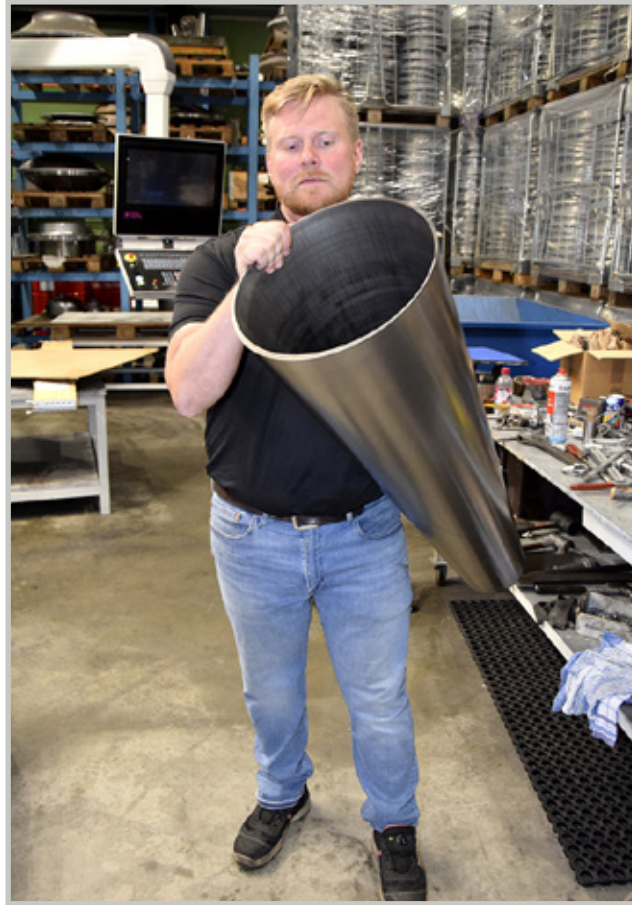
Näitä syntyy notkeasti painosorvaamalla. Hermann Hynninen tarkastelee paperiteollisuuden suuntaavaa kappaletta.
