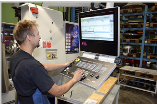
Uudessa koneessa on Siemens-ohjaus ja 6-paikkainen työkalurevolveri sekä numeraalisesti ohjatut lisätyöyksiköt. Ohjauksella Samuli Paavilainen.
