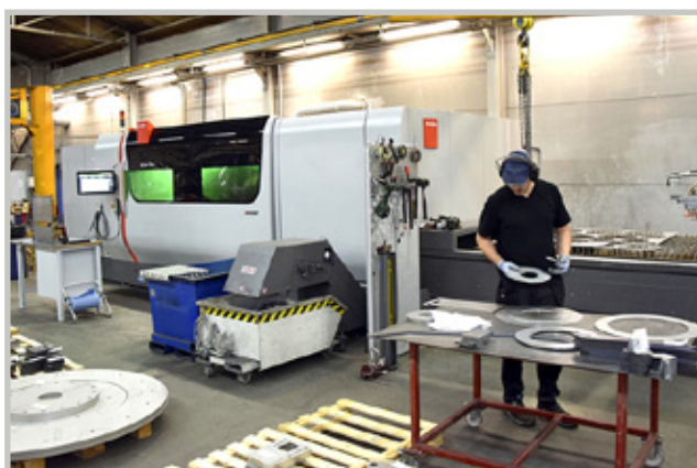
Työalue koneessa on 1500x3000 mm, levyjen käsittelyssä auttaa imukuppinosturi. Kappaleita erottelee Juhani Sorvali.
