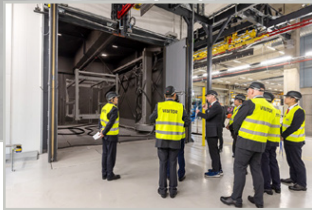
Automatisoitu jauhemaalauslinja korvaa nyt aiemman märkämäalausprosessin.
