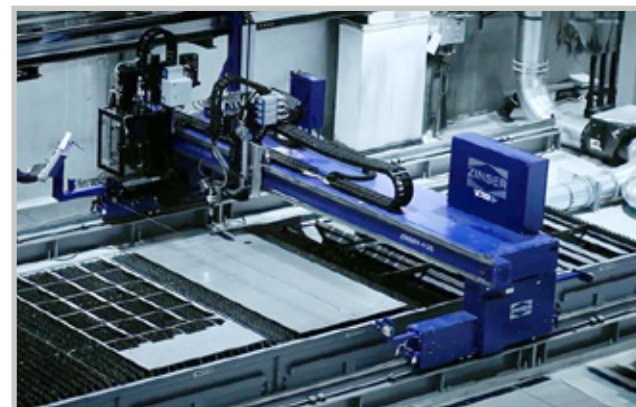
Staironille asennettiin keväällä Suomen ensimmäinen Zinser-plasmaleikkuri.
