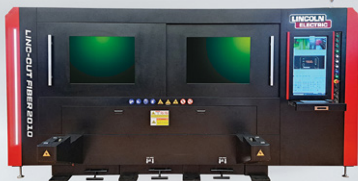
Linc-Cut Drawer -mallissa on koneen kyljestä ulos vedettävä leikkauspöytä, joten tilantarve on minimaalinen verrattuna vaihtopöytäisiin koneisiin.
