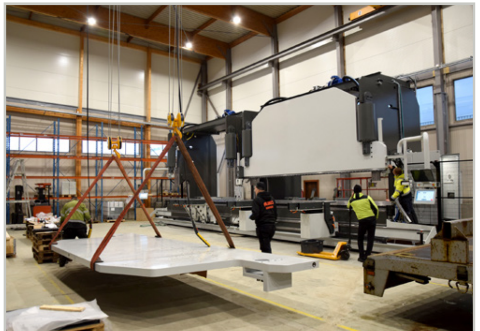
Rungon osat ovat kotimaista alihankintatuotantoa. Kuvassa käsitellään vasta saapunutta etupalkkia.
