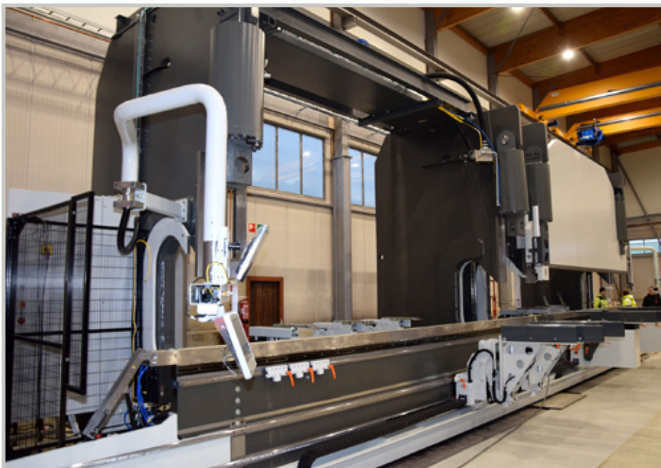
Lisälaitteita ja erikoisratkaisuja on mukana runsaasti. Tandemin koneissa ovat mm. vakiokoneita suurempi kitakorkeus ja kookkaat takavasteet. Kookkaiden kappaleiden käsittelyä auttavat jatkossa nosturit.
