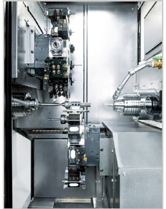
NT-Flex on uusi 2-revolverinen tarkkuussorvauskeskus 32 mm tankokapasiteetilla. Molemmilla työkalurevolvereilla on 12 moottoroitua työkalupaikkaa ja 24 indeksintiasemaa.
