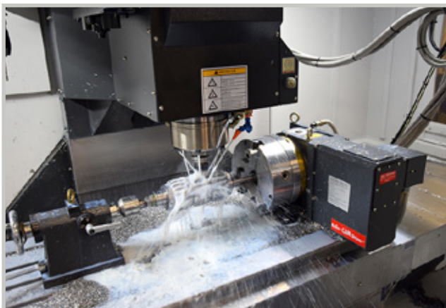
Työalue on kokoluokkaan nähden kookas. Oikealla 4. akselin roller cam -yksikkö.
