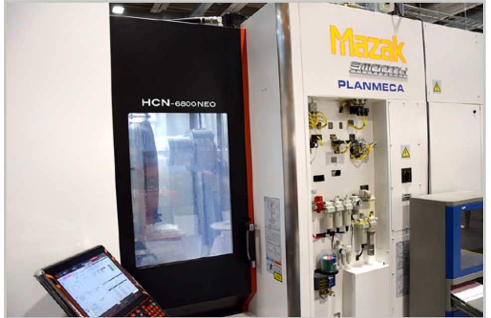
Modernia teknologiaa. Mazak HCN-6800 NEO:ssa suurin kappalekoko on 1050x1300 mm ja -paino 1500 kg. Built-in -jyrsinkara ISO50/HSK-A100 kartiolla eri vaihtoehtoin. Useita automaatiovaihtoehtoja, Planmeca koneen yhteydessä toimii Pallettech-automaatio.
