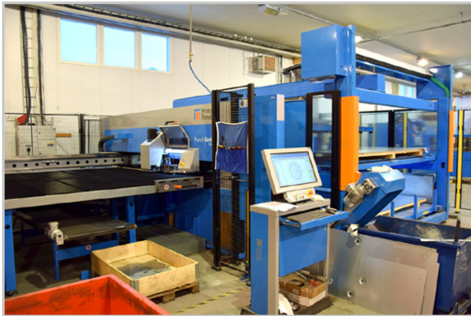
Lävistyskone PG 1530. Kone on varustettu automaattisella levynkäsittelyllä sekä kierteitysyksiköllä.
