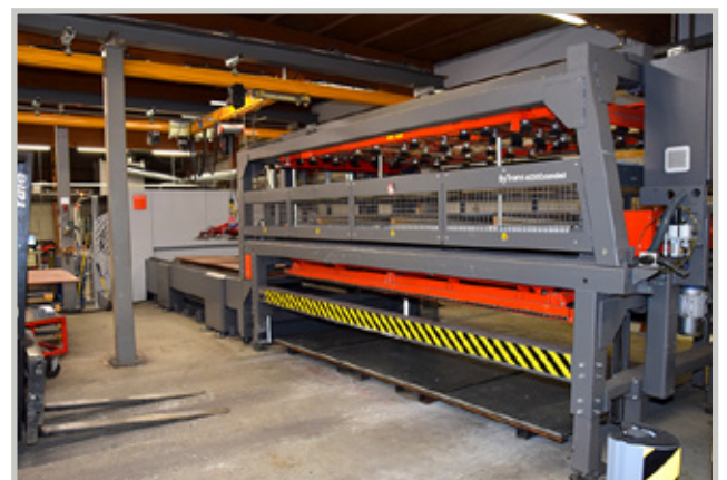
Levynekäsittelyä ByCutin yhteydessä automatisoi Bystronic ByTrans 4020 Extended.
