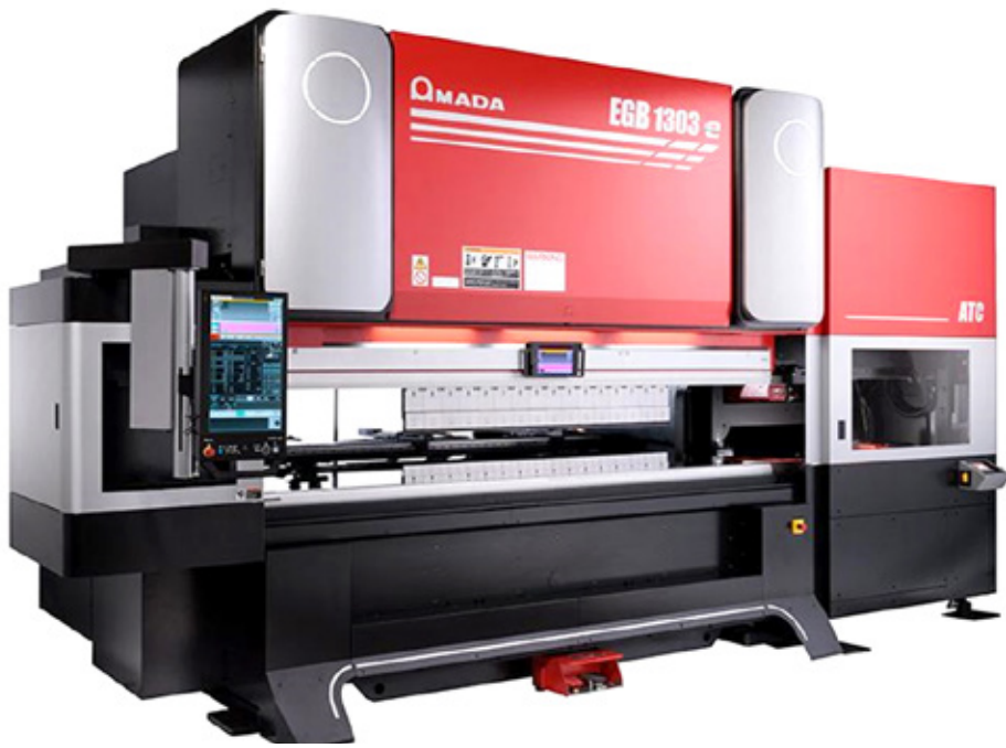
EGB-sarjaan kuuluu ergonomisia särmäyspuristimia, jotka ovat saatavana automaattisella työkalunvaihtajalla tai ilman sekä robottimalleja.
