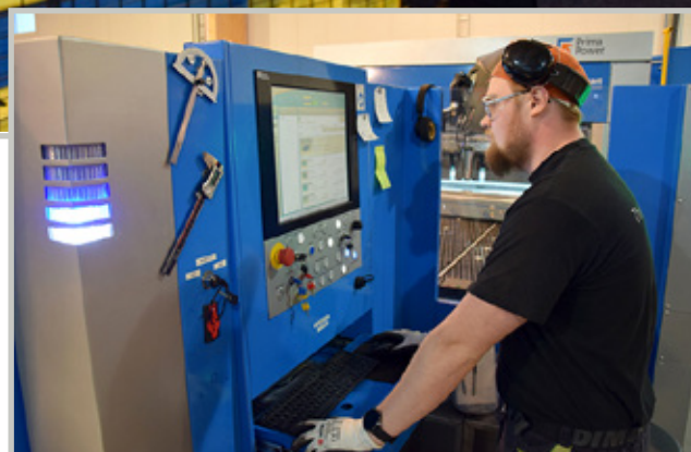
BCe Smart-taivutusautomaatti tarjoaa taivutuspuutua 2250 mm. Ohjauksella Toni Pitkänen.
