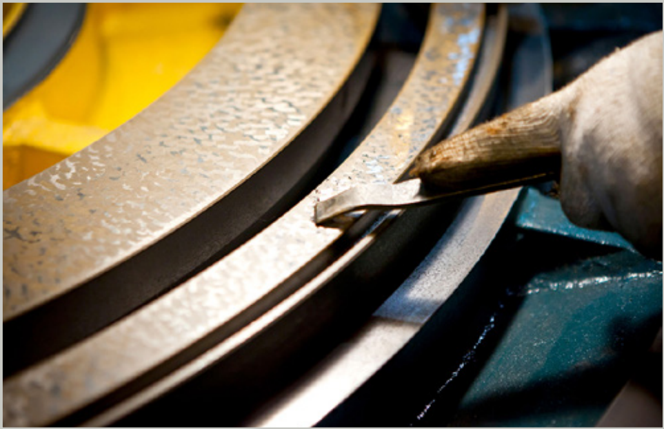
Pyöröpöytien johteet kaavitaan käsin, samoin kuin X-, Y- ja Z-akselien johteet.
