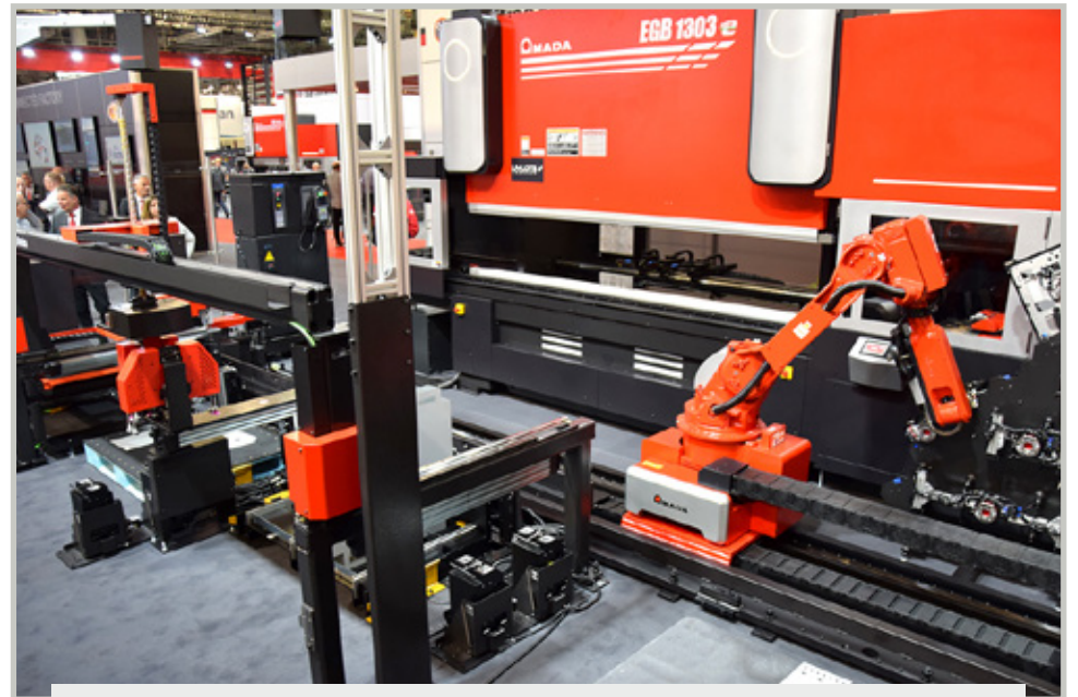
EBG 1303ARSe -solu työkaluautomaatiolla ja 20 kg robotilla esiteltiin syksyn EuroBLE-CH-tapahtumassa Saksassa. Optiona on saatavilla kokonaisuuteen Amada Smart Loadind Device, eli toinen robotti syöttää aihioita työtä tekeväälle robotille. Älykäs kameratunnistus helpottaa poimintaa ja pinoamista.
