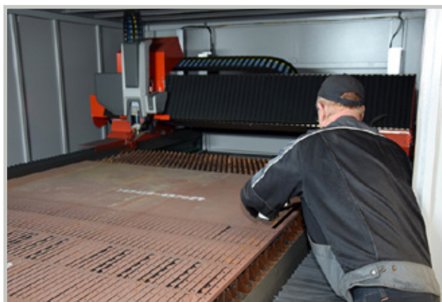
Uusi kone leikkaa teräkset 25 mm vahvuuksiin saakka ja mahdollistaa laajan materiaalikirjon. Resonaattoritietoa on 20 kW.
