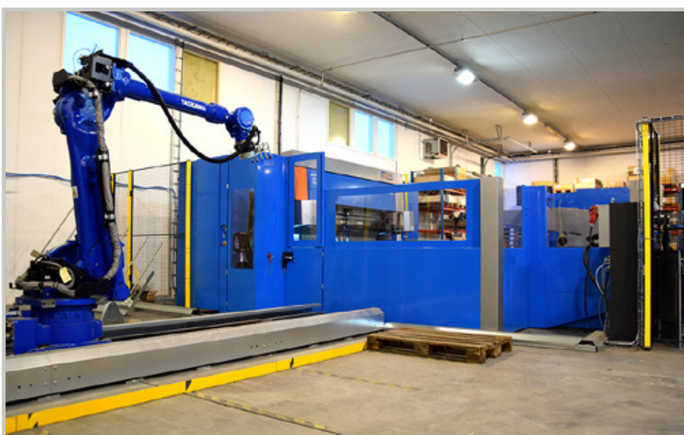
Pertemetin investointikokonaisuus nostaa tuotannon automaatioastetta. Myös uuden taivutusautomaatin materiaalinkäsittelyä automatisoi robotti.
