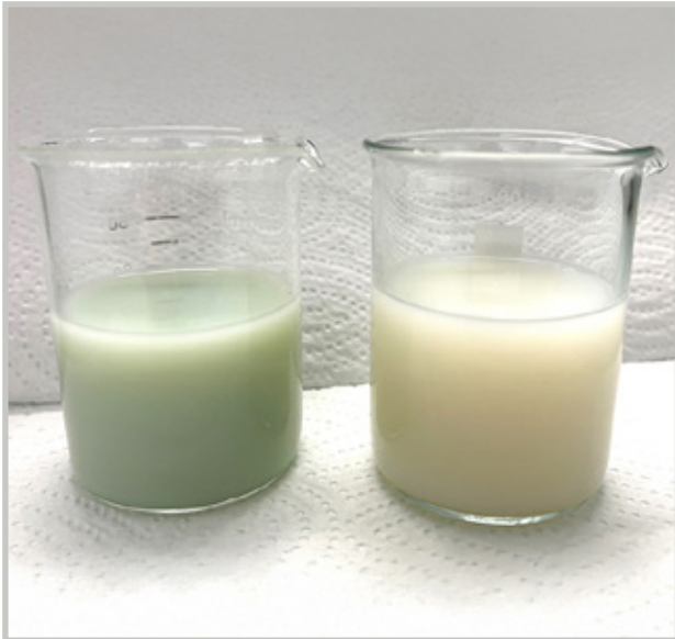
Kuparin kanssa kontaminoitunut vihertävä lastuamislisäaine (vasemmalla) verrokkina sama lastuamislisäaine ennen reagoimista kuparin kanssa (oikealla).
