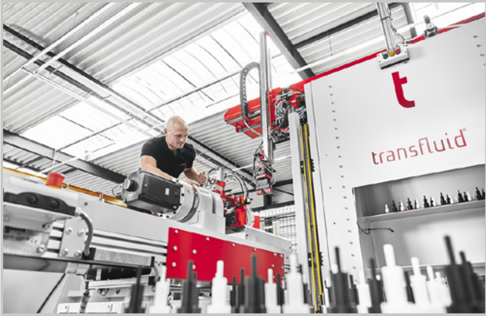
Transfluidin taivutuskoneet soveltuvat monidimensionaaliseen ja automatisoituun putkentaivutukseen.
