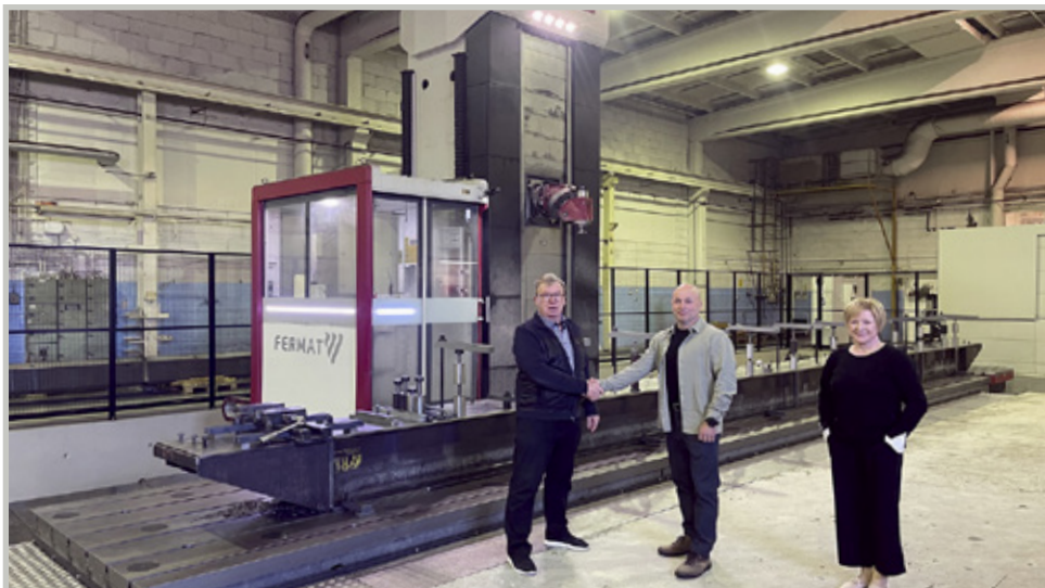
Vuodesta 2019 vuodesta asti käytössä olleesta Fermat Variant 10 000 liikealueet ovat X=15 m, Y=3,2 m, Z(RAM)=1,43 m ja 10 tonnin pyöröpöytä, jonka V-liike = 2 m. Kuvassa Hanna Auvinen, Timo Paananen ja Jarkko Vossi.
