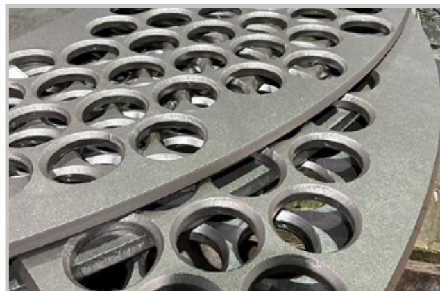
Siistiä jälkeä. Uudella laserilla syntyvät viisteet myös vahvempiin materiaaleihin.
