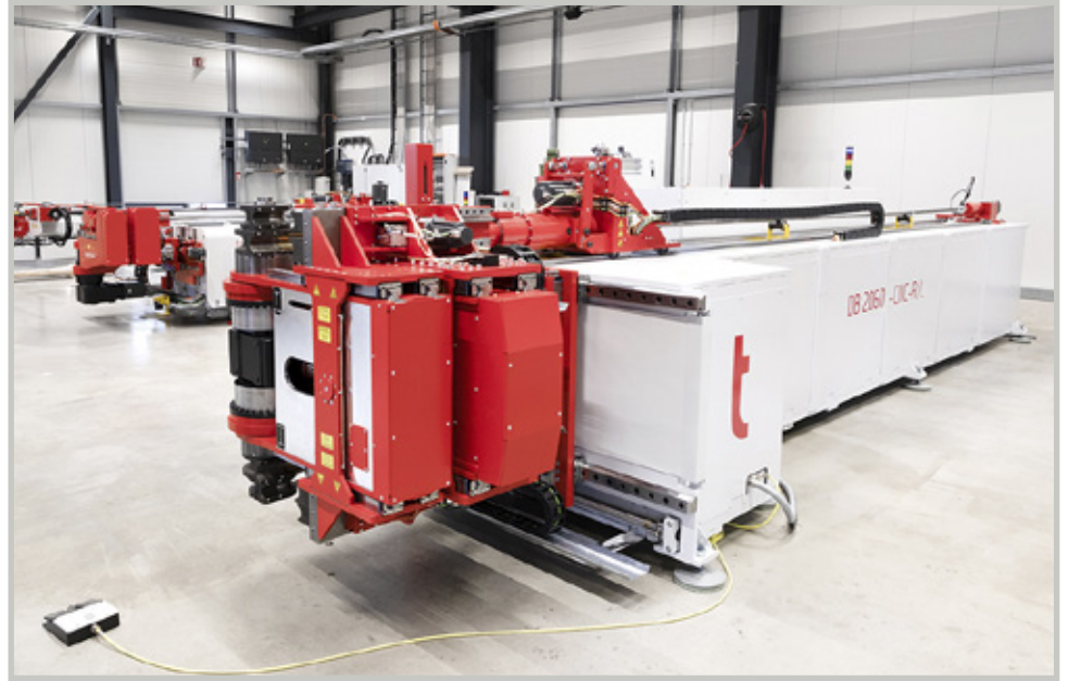
DB 2060 CNC RL -putkentaivutuskone kuuluu Transfluidin uuteen tarjontaan automaattisten putkentaivutuskoneiden sektorilla.
