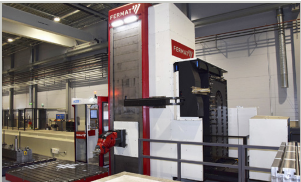
Uuden koneen työalue on mittava, liikkeet ovat X=20,2 m, Y=3,5 m, Z(RAM)=1,5 m.
