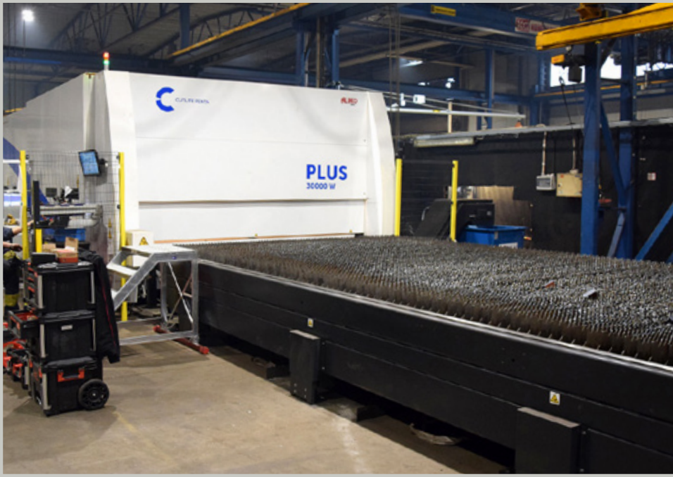
Lasertehoa koneessa on 30 kW ja pöytäkokoa 3050x6550mm.
