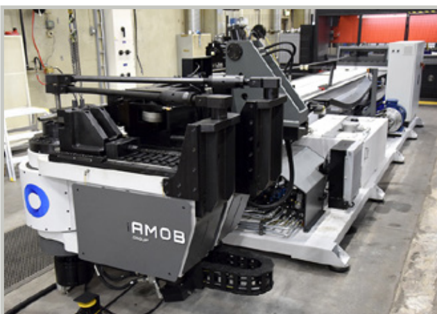
Clean Flamen uusi CH 120 CNC Booster on hydraulinen kolmiakselinen kone max. Ø120 mm:n halkaisijoille.
