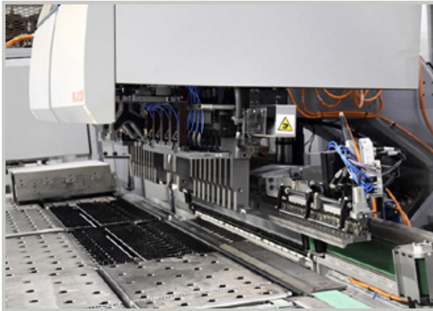
M-Levyn kone kone varustettiin mm. kuvassa näkyvällä Salvagnin patentimalla CLA-SIM -palaterätkaisulla sekä Taivuta ja leikkaa (Cut Option) -ominaisuudella.
