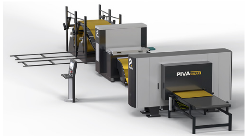
Konseptikuva uudesta PivaPunch PCC150-e TTI Compact-kelälävistyslinjasta joka on varustettu MultiCoil-kelankäsittelyratkaisulla.
