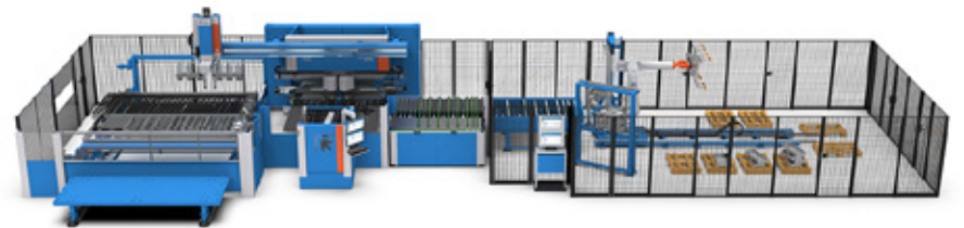
Prima Powerin taivutusrobottisolu, joka integroi taivutettujen kappaleiden purkamisen ja pinoamisen 7-akselisella antropomorfisella robotilla sekä poiminta- ja keskityslaitteella (PCD) varustetun Express Bender EBe -taivutusautomaatin.
