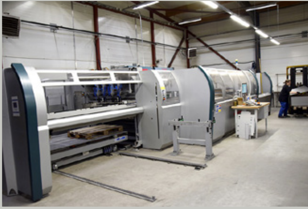
Tuotannossa taivutusautomaatti taivuttaa levyä tuotteeksi.
