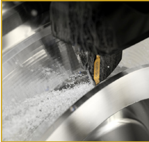
Uusi terägeometria sisältää nikkelipohjaisille HRSA-materiaaleille tarkoitettua hiotun muotojyrsintägeometrian -RO.
