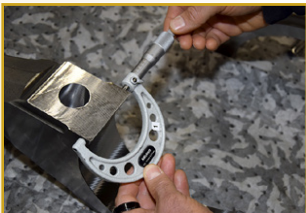
Laadunhallinta lukuisine mittauksineen on Purso-Toolsilla jatkuva prosessi. Kuvassa perinteistä mittausta kaarimikrometrillä.
