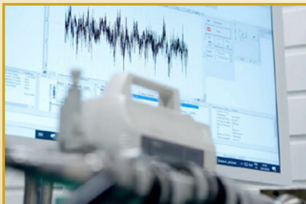
Pinnankarheuden mittaus, laitteena Mitutoyo Surftest SJ-500P.
