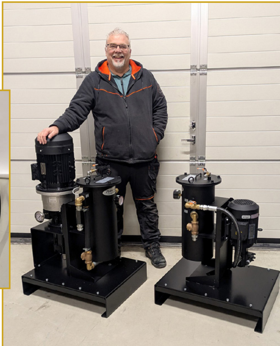
Compact-järjestelmä koostuu korkeapainepumpusta, cyclonisuo-dattimesta ja syöttöpumpusta.
