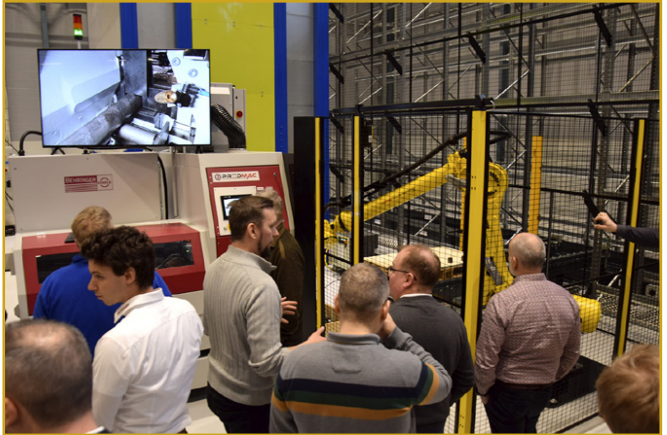
Esillä olleeseen tuotantokokonaisuuteen kuuluivat saha sekä koneistuskeskus kappaleenkäsittelyltään automatisoituina, automatisoitu teollisuuspesukone, varasto sekä AGV-vaunu. Kuvassa solun pyörösaha Behringer HCS-150E.
