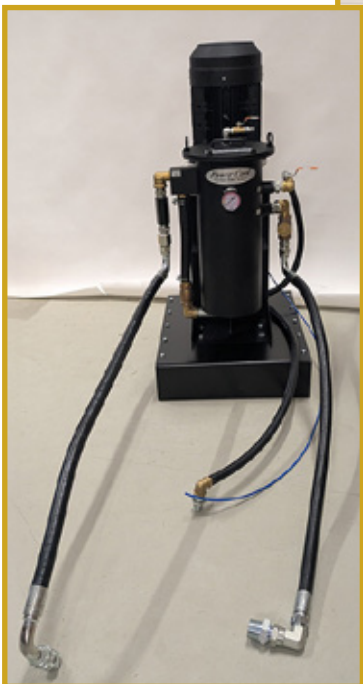
Compact-järjestelmä koostuu korkeapainepumpusta, cyclonisuo-dattimesta ja syöttöpumpusta.
