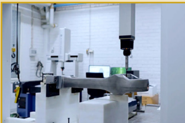
Mittaustyö käynnissä Crysta Apex 122010:lla.
