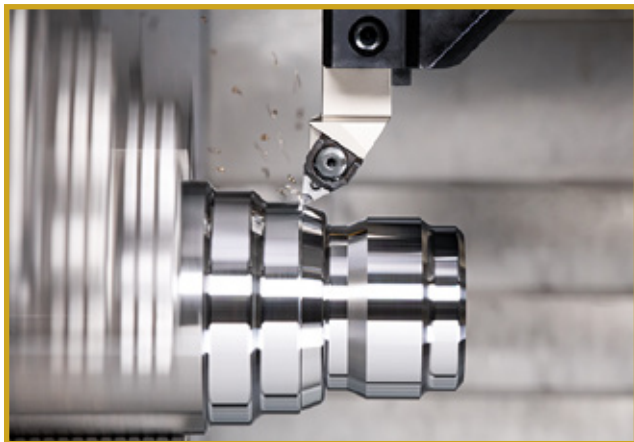
Uusi 16 mm kääntöterä on monipuolinen ratkaisu sorvaukseen.
