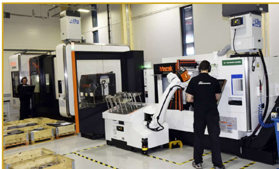
Uuteen hallilaajennukseen sijoittuu mm. uusi Mazak QT 250MY -monitoimisorvi robotisoidulla kappaleenvaihdolla.
