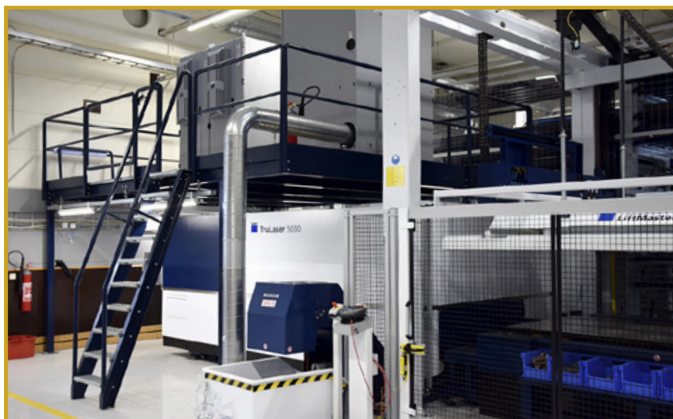
Linja on täysautomaattinen levyjen kuormauksen, leikkauksen, tuotteiden purun ja robotilla tapahtuvan lajittelun osalta, myös manuaalinen lajittelu on mahdollinen tarvittaessa.
