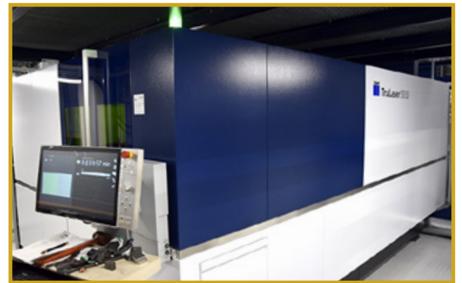
Automaatiokokonaisuuden ydin on 1,5x3 metrin levyjen käsittelyyn tarkoitettu TruLaser 5030 Fiber L76-laserleikkaukone 6 kW:n tehoin.
