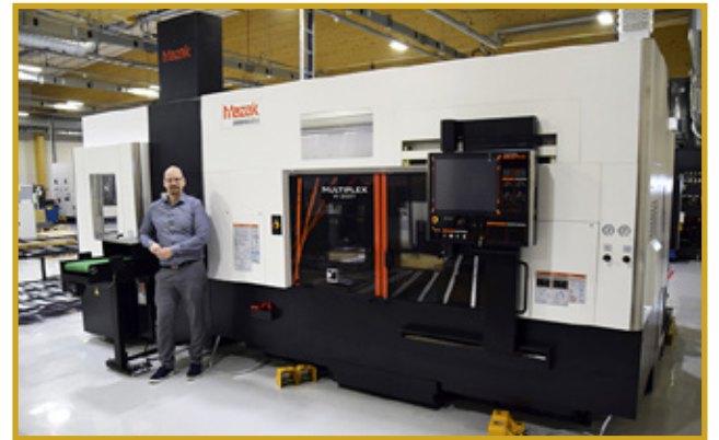
Helmikuussa asennettu Mazak Multiplex W-200Y tehostaa Eskomaticilla mm. laippamaisten kappaleiden tuotantoa.
