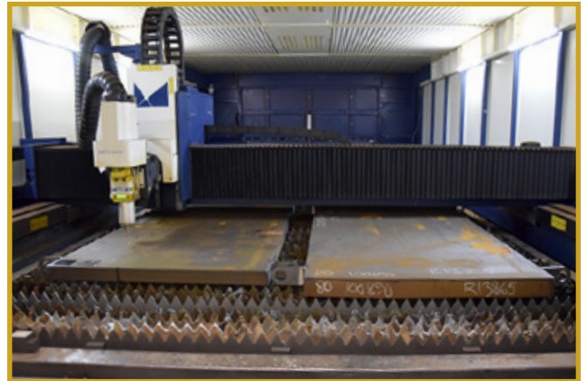
40 kW:n teholla koneella voidaan leikata jopa 100 mm:n vahvuisia levyjä. Kappaleen vahvuus kuvassa on 80 mm.
