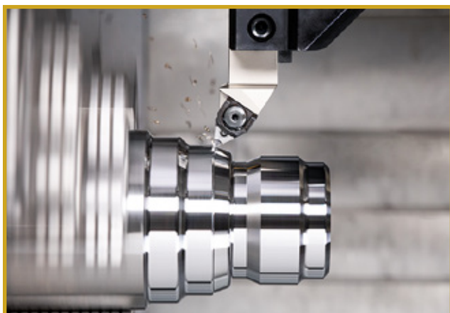
Uusi 16 mm kääntöterä on monipuolinen ratkaisu sorvaukseen.
