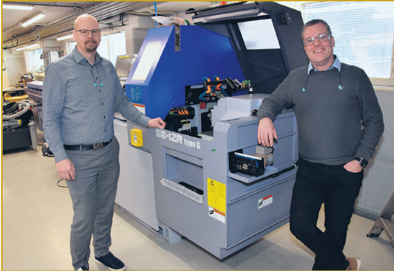
Eskomatic Oy jatkaa aktiivista panostusta koneistusteknologiaan. Uusi Star SB-12R mahdollistaa pienten hienomekaanisten osien tehokkaan sarjavalmistuksen, kertovat Reino Lönnroth ja Pauli Eskola.
