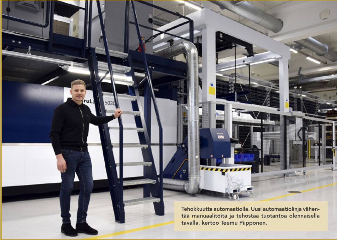
Sopiva lay-out käytettävissä olevaan tilaan. Varasto on kaksipuolinen, laserleikkaukoneen oheislaitteet on sijoitettu lattiatilaa säästään toiseen kerrokseen.
