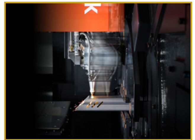
U-akselilla varustettu leikkauspää mahdollistaa nopean leikkauksen materiaalia siirtämättä.
