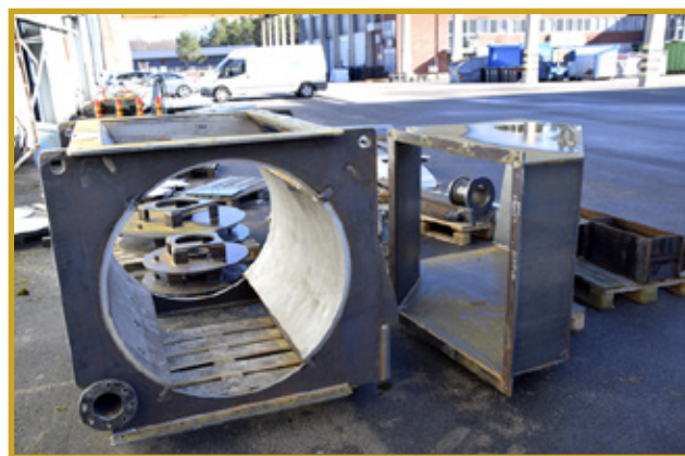
Toinen tuotealue on kuvan kaltaisten murskainten sulkusyötinien runkovalmistus.
