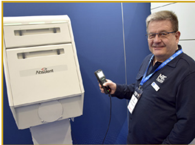
Kompaktia öljysumusuodatusta: Jukka Yläpoikelus esitteli MTC Flextekin osastolla Absolentin uuden AW-sarjan HEPA H 13-luokan suodatusratkaisuja. Sisäänrakennettu älykäs ohjaus, sijoitus koneen katolle tai lisäjalalle. Pienin kapasiteetti malleissa on 250 kuutiota tunnissa, isoin 800 kuutiota tunnissa.
