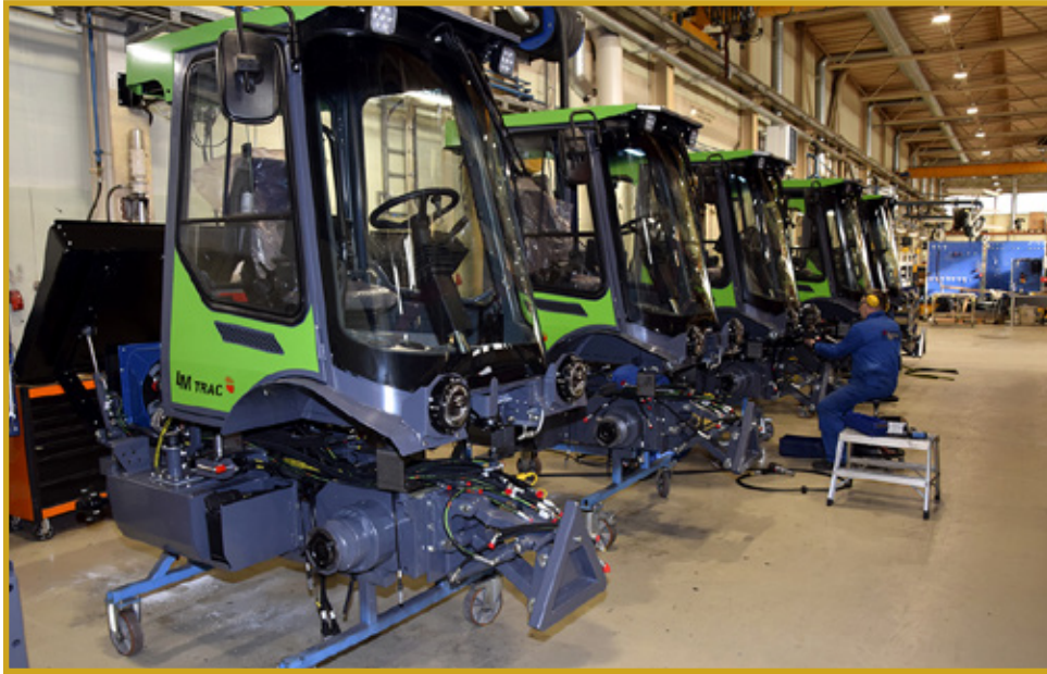
Lai-Mun tuotteita ovat turvaohjaamot ja monitoimikoneet. Kuva kokoonpanosta.
