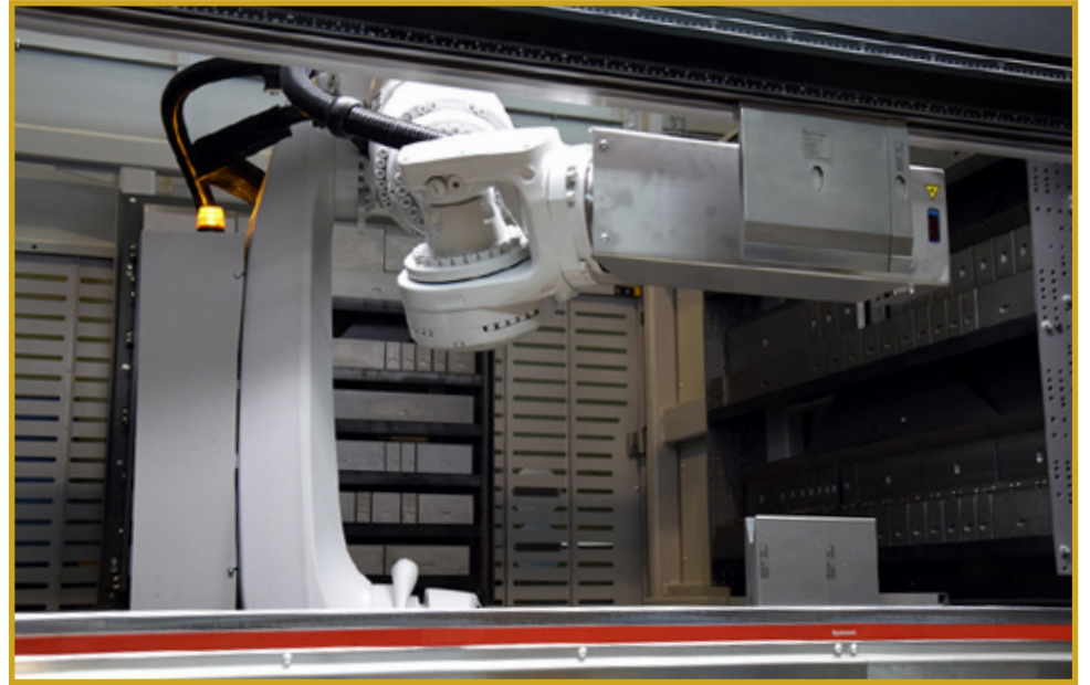
Työkalunvaihtorobotin kuormakapasiteetti on 25 kiloa.
