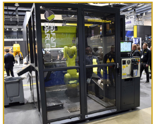
Tehokas särmäyssolu. Machinery MT:n osastolla kohosi SafanDarley Mini Cell, täysin sähköinen, kokonaisuudessaan automatisoitu särmäysrobotisolu. Solussa ovat mukana E-Brake 35T Mini Cell -särmäyspuristin, kapasiteetiltaan 25 kg:n robotti, kaksi syöttöisempää, talletusasema ja poistoluiska. Levykoko käsittelyyn max. 600 x 800 mm.
