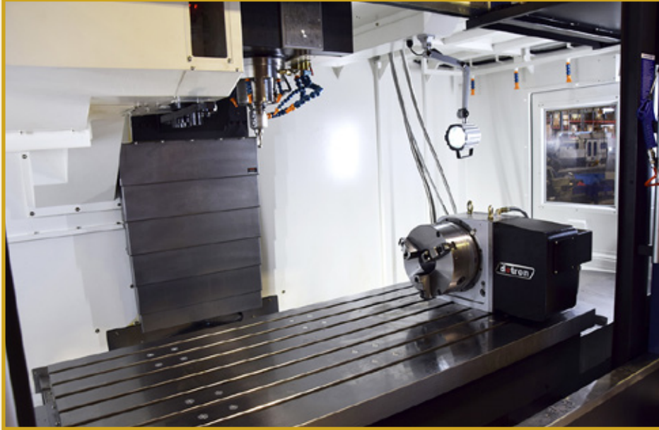
X/Y/Z- liikkeet koneessa ovat 1630/815/700 mm, neljäs akseli lisää toiminnallisuutta.
