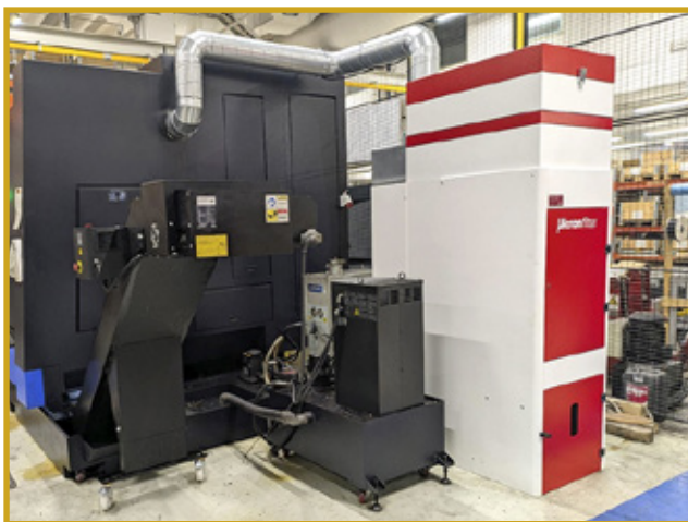
Suuri työstökone vaatii tehokkaan suodatuksen, kuvassa Eco-tech 4000 öljysuimuri ja Tekupitin samaan koneeseen toimittama lastunkuljetin
