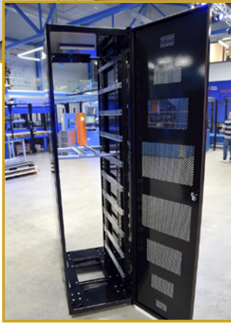
Levyistä kappaleiksi ja tuotteiksi. Demoissa valmistettiin ohutlevyosia mm. kuvassa näkyvän kaltaisiin datakeskuksen palvelinkaappeihin, sähköjärjestelmän kytkinkaappeihin sekä generaattorin suojakoteloihin.
