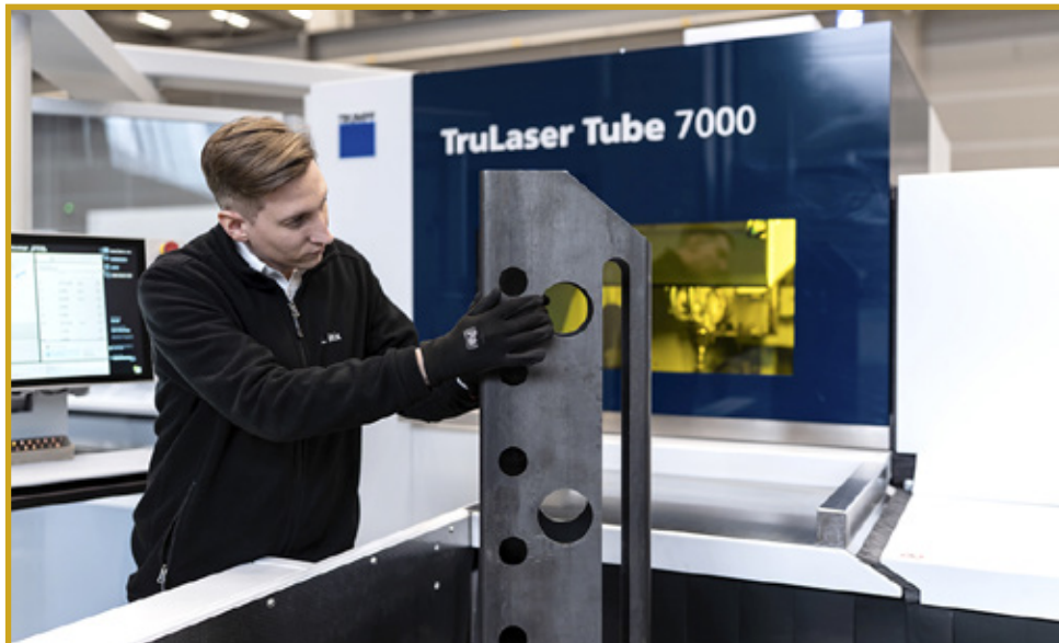
Ison työalueen ansiosta TruLaser Tube 7000 sopii sekä pienten että suurempien kappaleiden käsittelyyn
