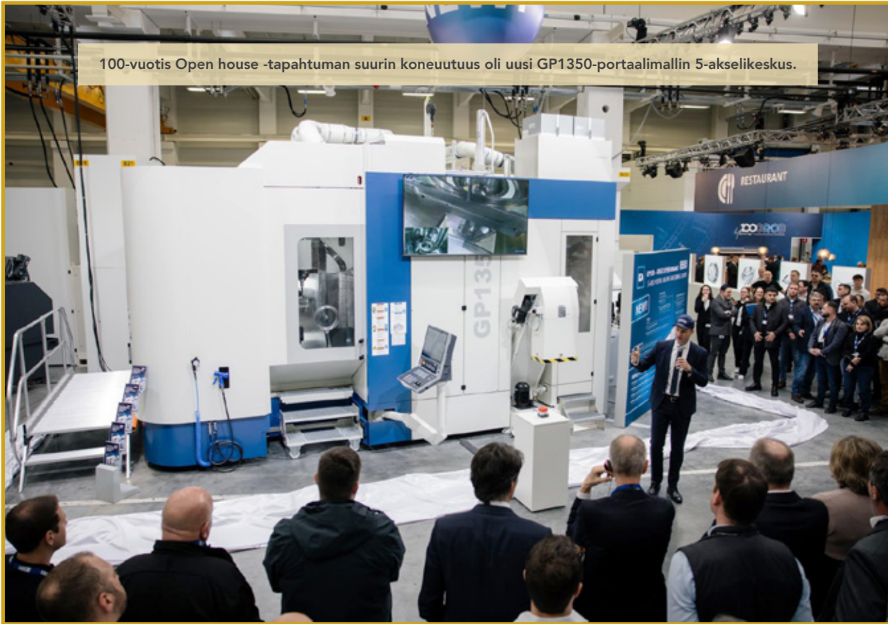
Uuden GROB GP1350 liikkeit X/Y/Z=1400/1950/1100 mm, työkappalekapasiteetti \varnothing 1400x1100/ \varnothing 1250x1100 mm sekä pöytä/paletti \varnothing 1400/1250x1100 mm, 3600 kg asti.
