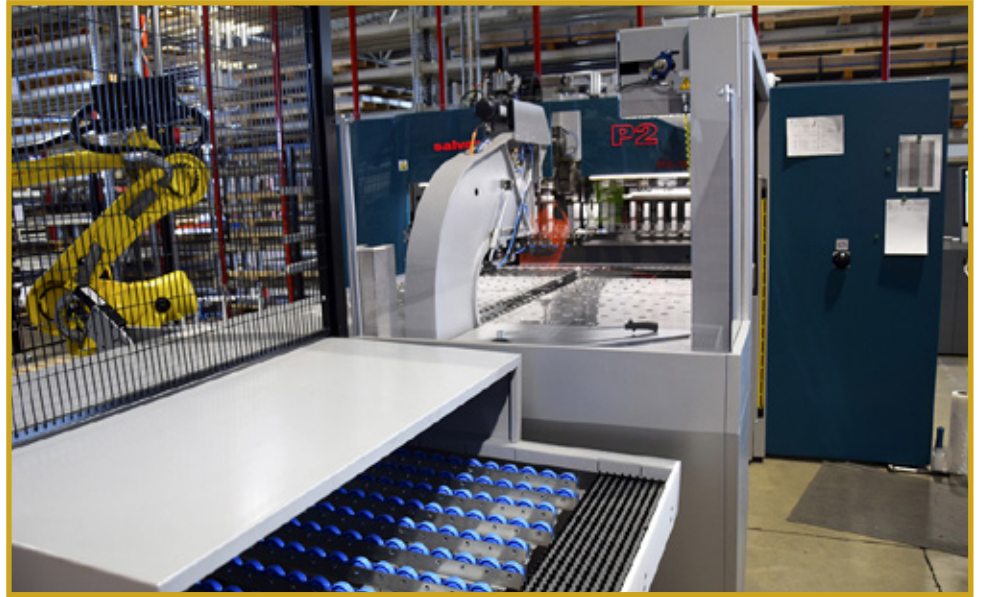
Taivutustyöt solussa tekee Salvagninin P2-taivutusautomaattimalliston tuorein jäsen P2.G4-1620, missä taivutusputuus on 1,6 metriä. Kone lanseerattiin Salvagninin mallistoon noin vuosi sitten.
