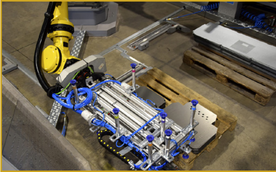
Älykäs skannaus. RVS-konenäön avulla solun P-Robot 3D- skannaa taivutettavan aihion ulko-geometrian ja paksuuden automaattisesti.
