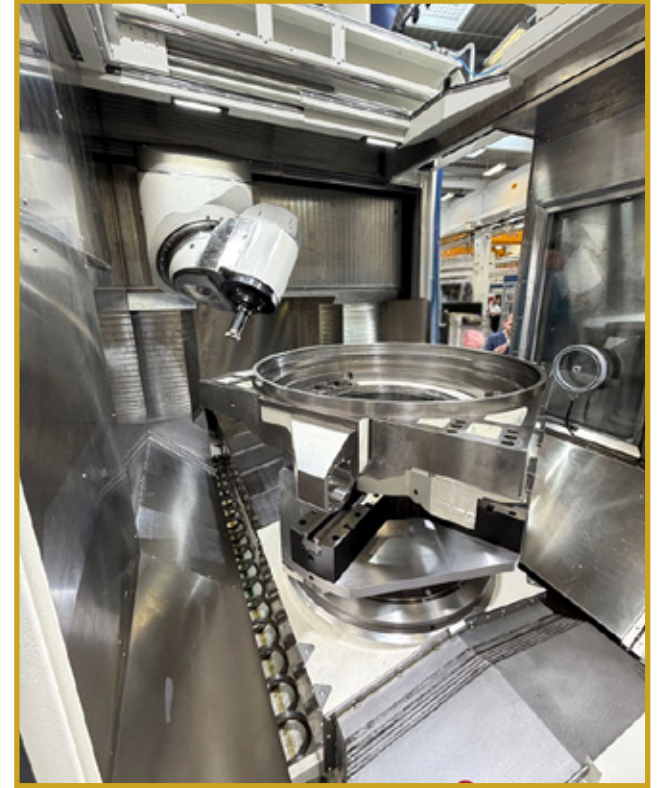
Uuden GROB GP1350 liikkeit X/Y/Z=1400/1950/1100 mm, työkappalekapasiteetti \varnothing 1400x1100/ \varnothing 1250x1100 mm sekä pöytä/paletti \varnothing 1400/1250x1100 mm, 3600 kg asti.
