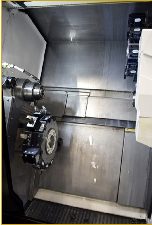
Työaluetta. Kaksikaraisen, kaksirevolverisen koneen sorvaushalkaisija on 225 mm, ja -pituus 685 mm. Tankokapasiteetti on 51 mm.
