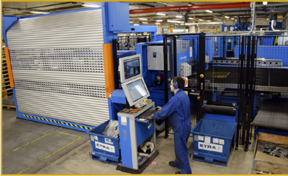
Kompakti, käytettävissä olevaan tilaan sopiva järjestelmä. Kombikone leikkaa, lävistää ja kierteittää kappaleet yhdessä kokonaisuudessa.
