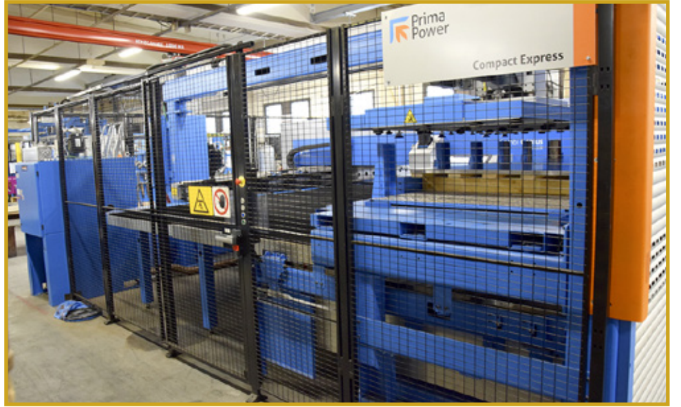
Automaattinen materiaalinkäsittelylaite Compact Express on mukana hoitamassa materiaalin lastaukset ja purut.
