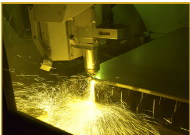
Leikkaustehoa koneessa on 20 kW. Paineilmaleikkaus teräksillä sujuu hyvin 20 mm:n vahvuuksiin saakka.
