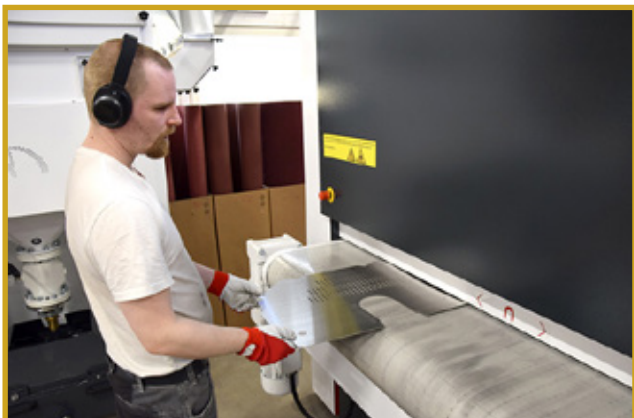
Viimeistelyä jälkeä. Kone mahdollistaa kappaleiden käsittelyn leveydeltään 50 mm:stä aina 1525 mm:iin saakka.
