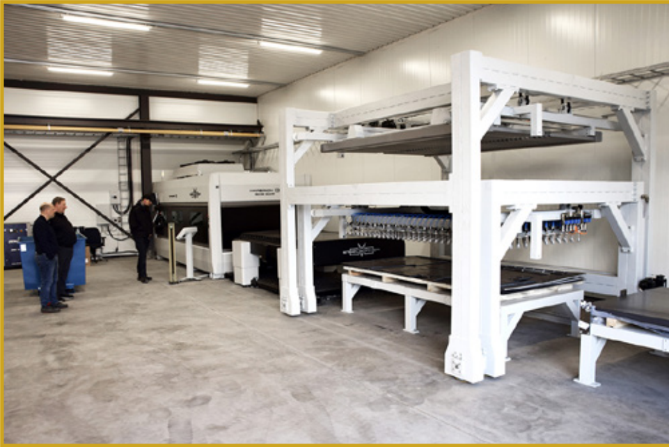
Järjestelmässä laserleikkauskone on Steelburner Hyperion Q. Levyn lataus, purku ja poiminta ovat kokonaisuudessa automatisoituja toimintoja.
