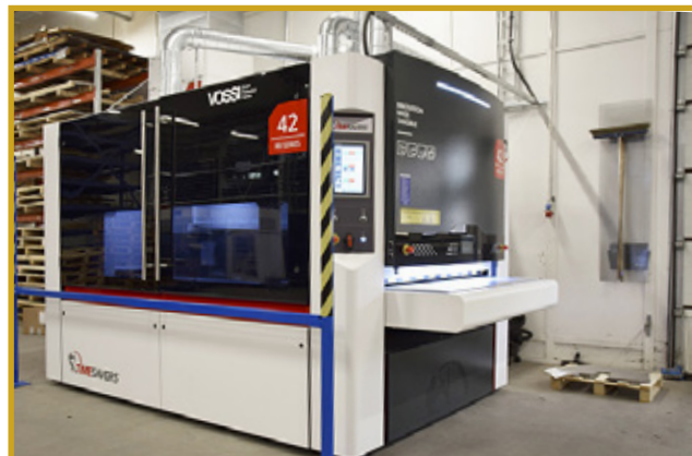
Monipuolinen paketti. Kone voidaan varustaa niin purseenpoistoon, reunojen pyöritykseen sekä myös laseroksidin ja raskaan kuonan poistoon ja muuhun viimeistelyyn.
